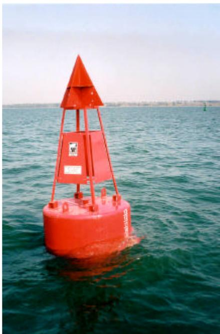
Figura 3.7 – Bóia de Boreste para Balizamento em Reservatório no Rio Paraná
