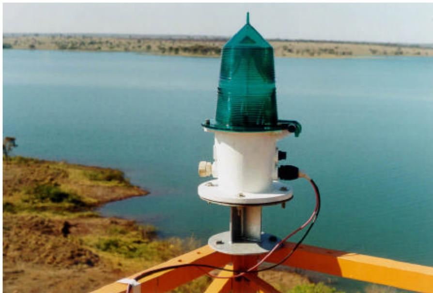
Figura 3.12 – Detalhe do Vidro Refletor do Faroete de Bombordo
