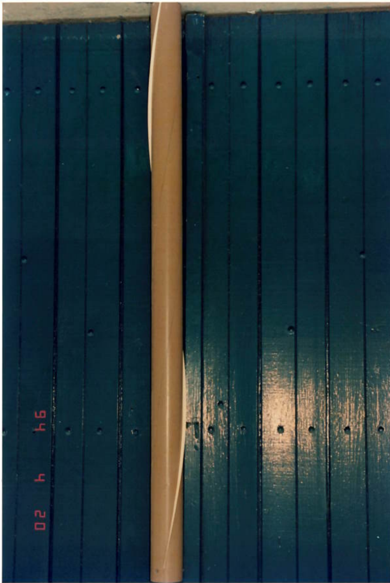
Foto 8 - Modelo com Supressor Tipo Strake , 01 Strake , Altura 0,10 D e Passo 18 D (Modelo B)
