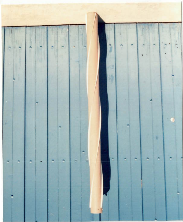
Foto 3 - Modelo com Supressor Tipo Strake , 03 Strakes , Altura 0,10 D e Passo 18 D
