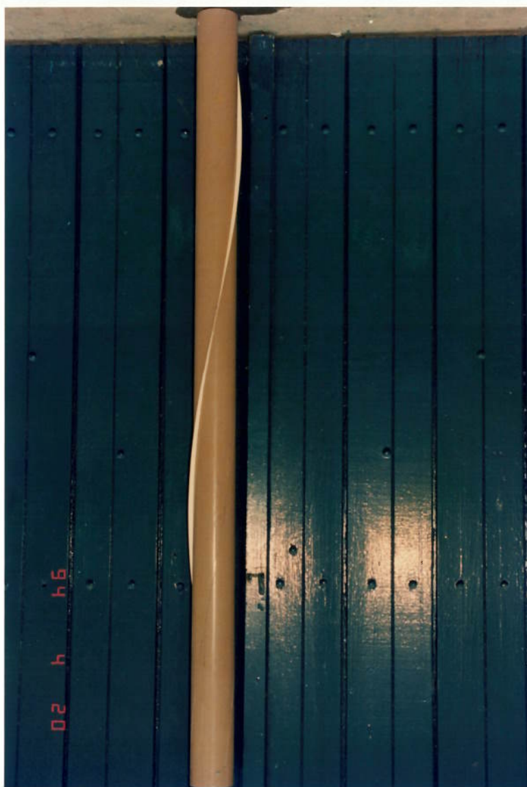
Foto 7 - Modelo com Supressor Tipo Sirake , 01 Sirake , Altura 0,10 D e Passo 18 D (Modelo A)
