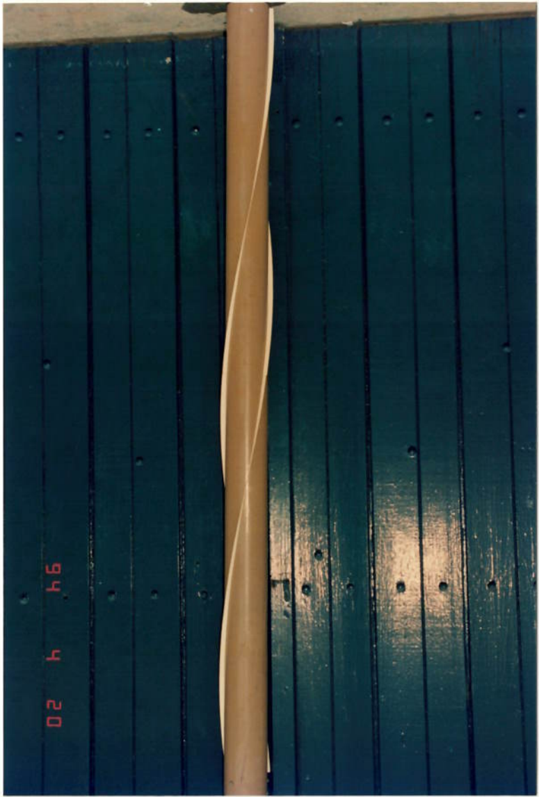
Foto 5 - Modelo com Supressor Tipo Strakes , 02 Strakes , Altura 0,10 D e Passo 18 D (Modelo A)
