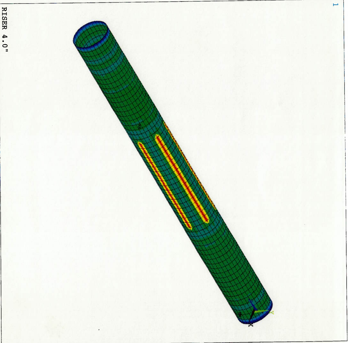
Figura 5.13 - Tensões de VonMises na camada de pressão do " riser " de 4 polegadas ( vista geral )
