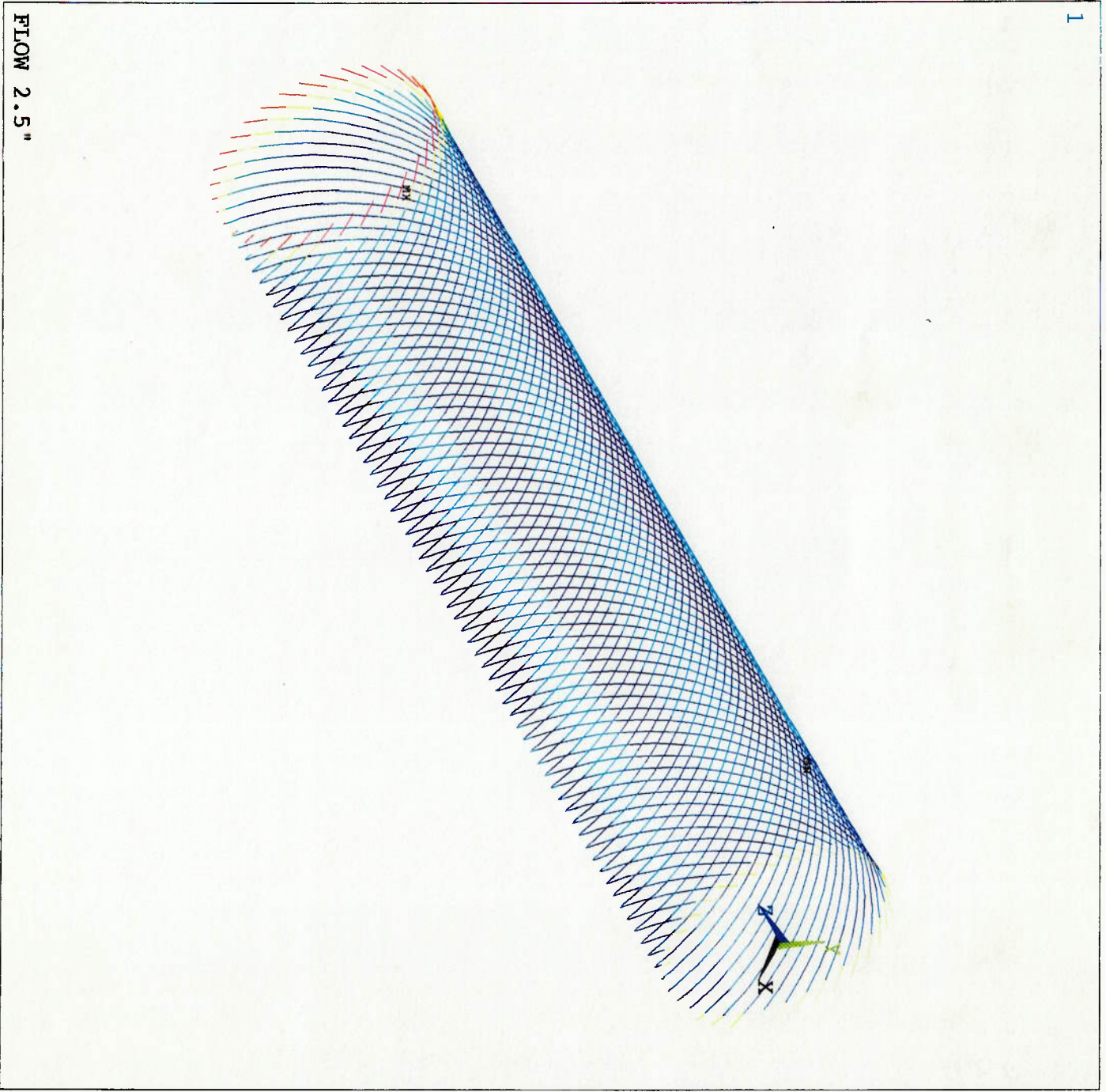
Figura 5.2 - Tensões máximas na armadura externa de tração do "flowline" de 2 1/2 polegadas
