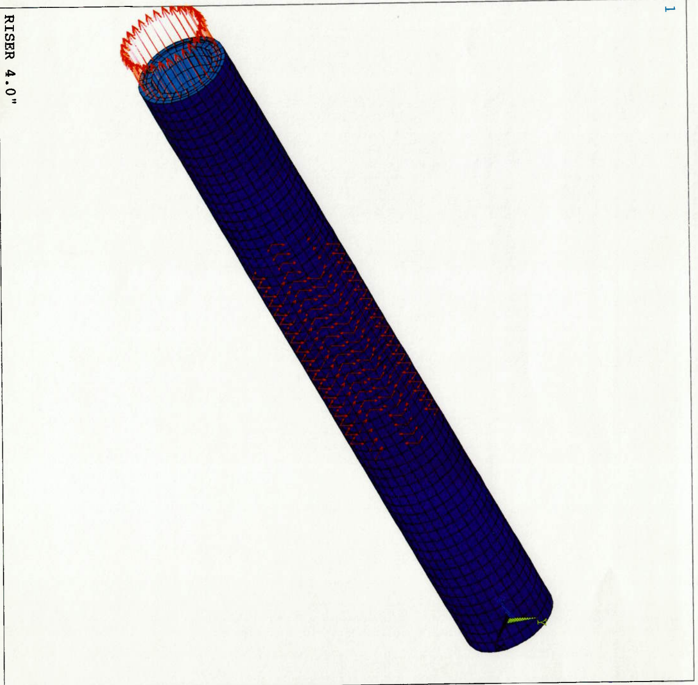
Figura 5.7 - Cargas aplicadas no "riser" de 4 polegadas ( vista geral )
