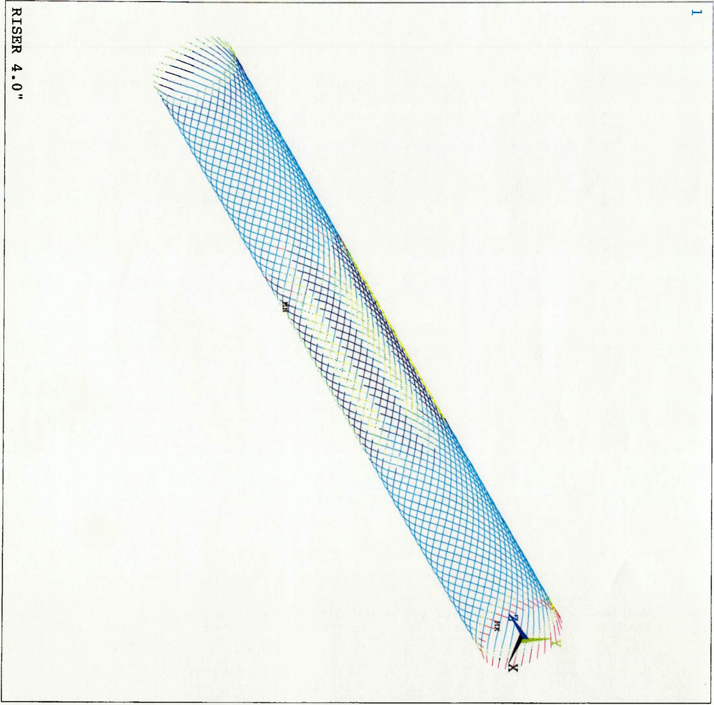
Figura 5.11 - Tensões máximas na armadura externa de tração do " riser " de 4 polegadas
