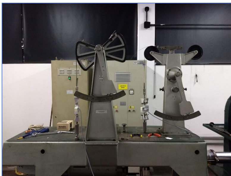
Figura 18 – Fotografia da saída do eixo do propulsor no túnel de cavitação do IPT com a balança dinamométrica para medição de torque e empuxo.
