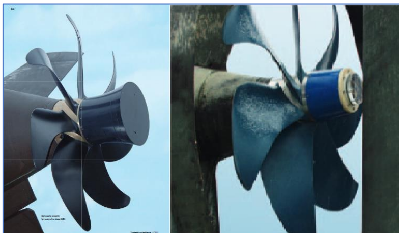
Figura 6 - Exemplos de propulsores com bossô divergente em veículos submarinos.
