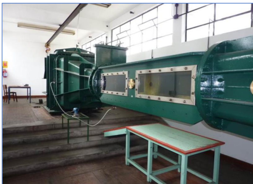
Figura 17 – Foto da seção de testes do túnel de cavitação do Instituto de Pesquisas Tecnológicas.
