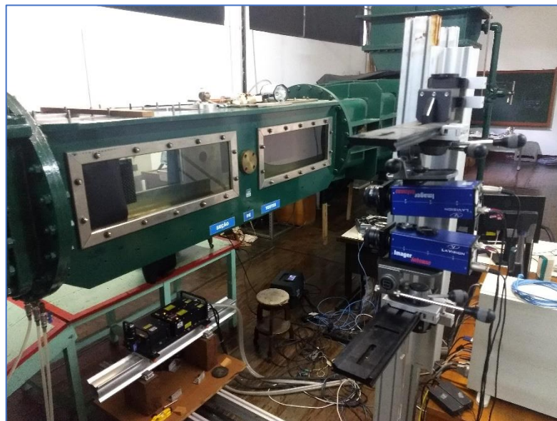
Figura 19 – Arranjo do sistema PIV instalado no túnel de cavitação do IPT.
