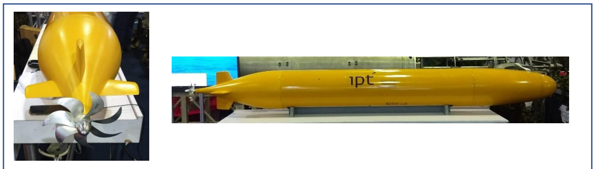
Figura 1 – Propulsor Mod5 instalado em um protótipo de AUV.
