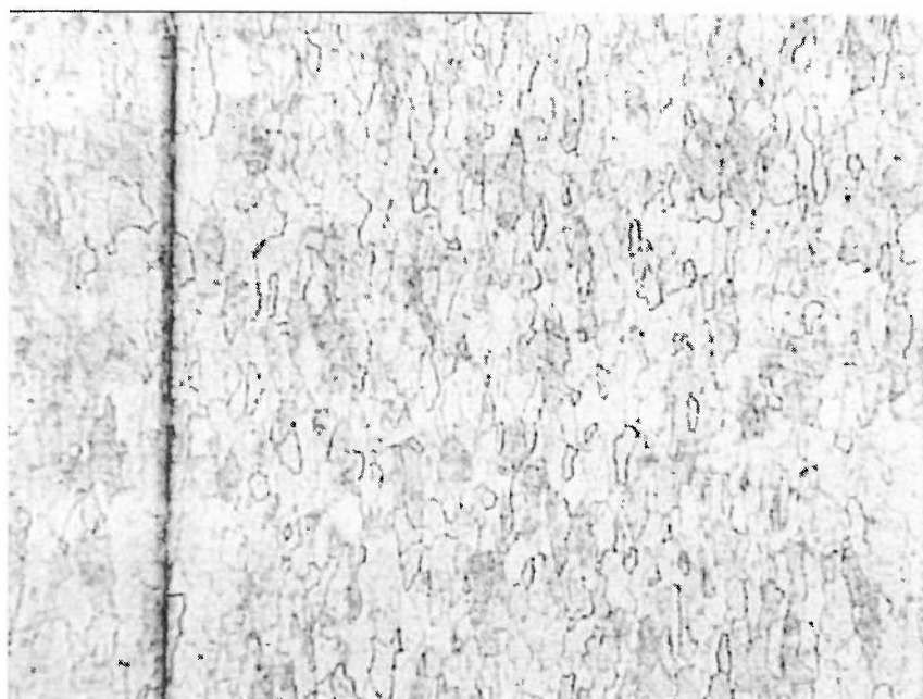
Figura 46: Micrografia da Amostra 12. ABNT 1006. Grau de redução 20 %. Estado Encruado. Ataque nital 4%. Aumento 100X.
