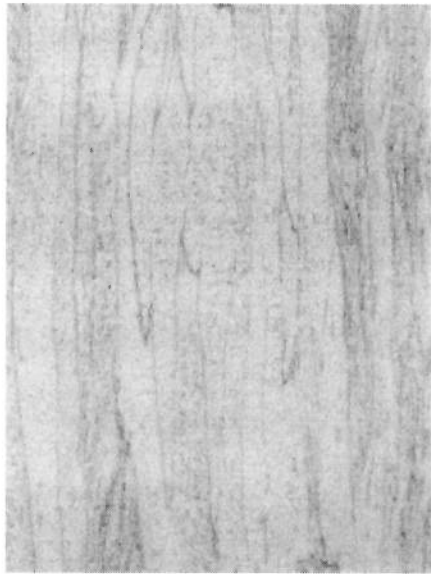
Figura 48: Micrografia da Amostra 14. Aço Silício no estado encruado antes de ser submetido a (700°C/8 h). Ataque nital 4%. Aumento 200X.
