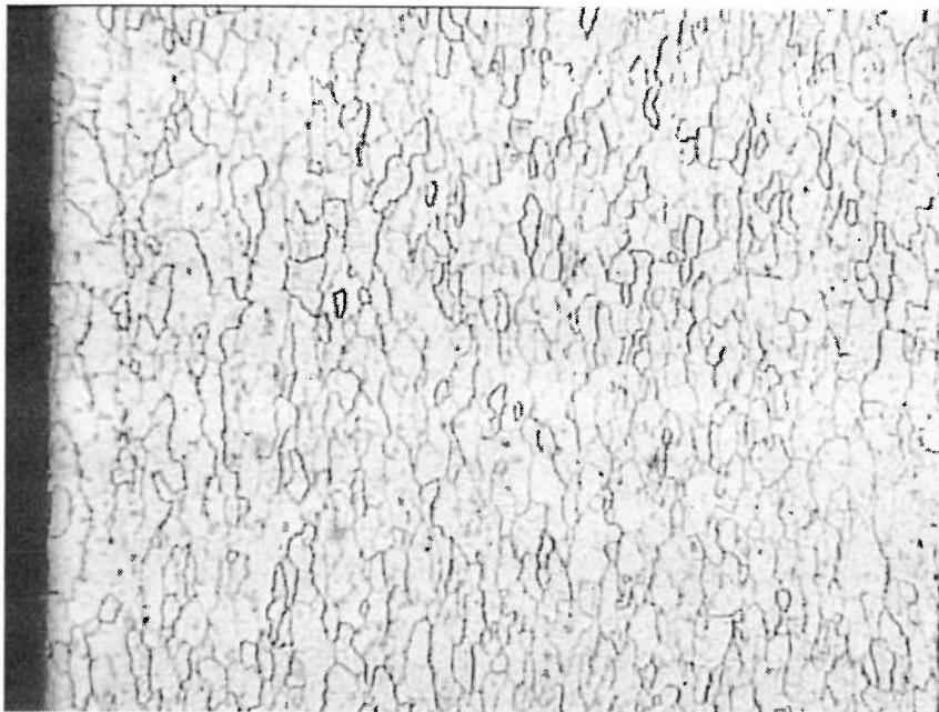
Figura 42: Micrografia da Amostra 10. ABNT 1006. Grau de redução 12 %. Estado Encruado. Ataque nital 4%. Aumento 100X.
