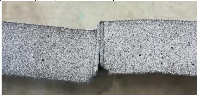
Figura 48: corpo de prova deformado após o término do ensaio FPAB.
