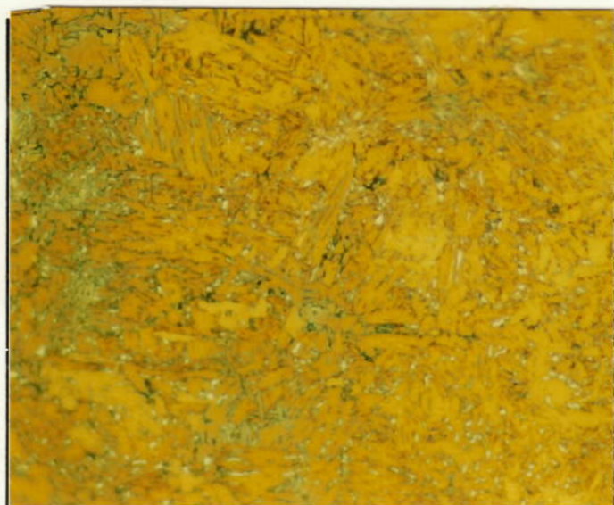
Fig. 4.8 Fotomicrografia da ZFL na ZTA (amostra 9-aço 1). RGG com ferrita e bainita e martensita (partículas brancas). Ataque: Le Pera 500 x.
