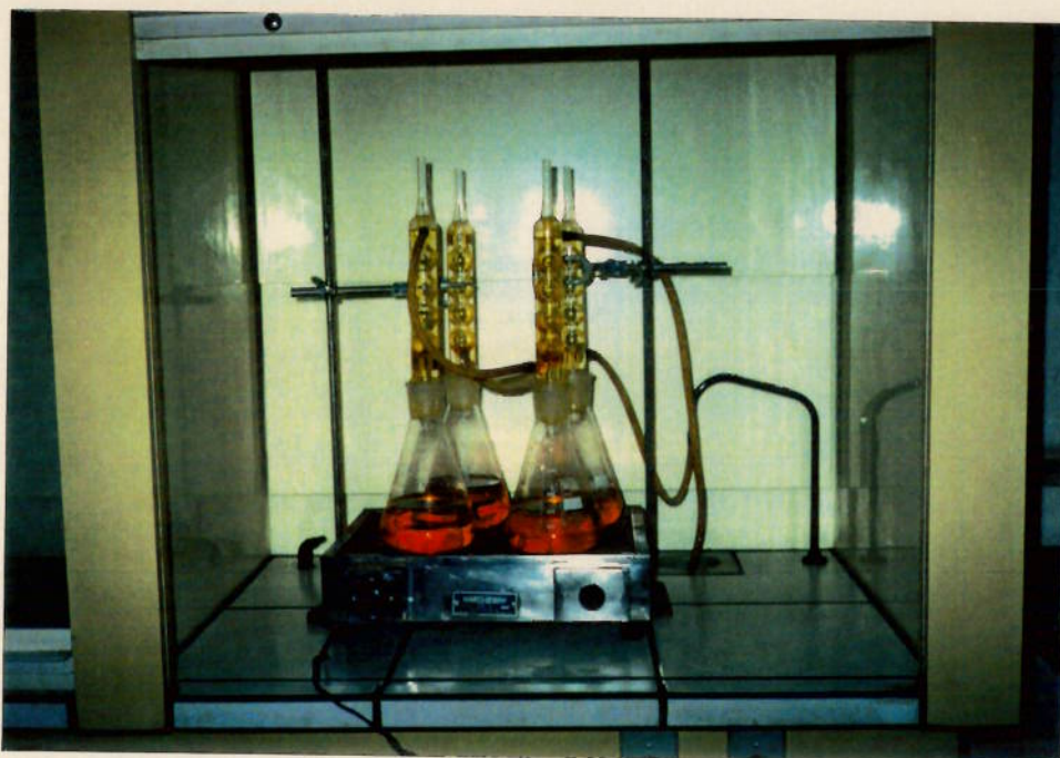
FIGURA 38- Bancada para os ensaios de perda de massa (ASTM A 262 - práticas B e F).
