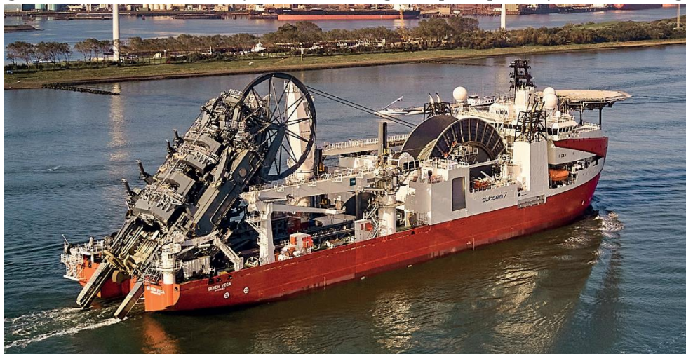
Figura 2 – Navio de instalação de dutos rígidos para produção de óleo e gás.
