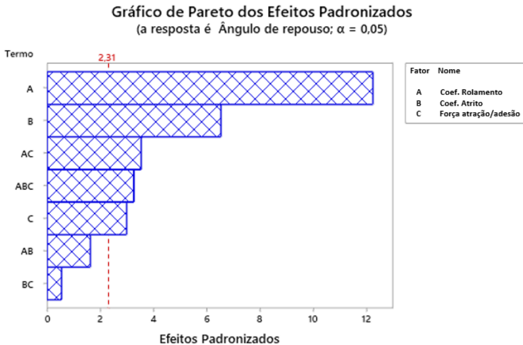
Figura 39 - Gráfico de Pareto para resposta em ângulo de repouso (teste de escoamento livre)
