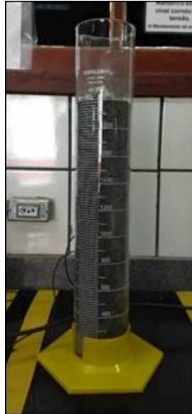
Figura 31 – Determinação da densidade aparente em proveta
