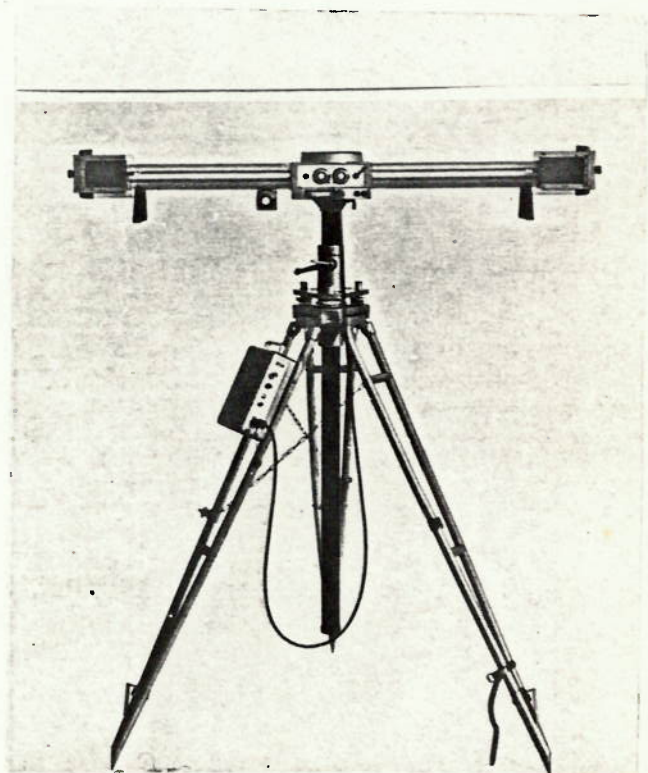
Fig. 14- CÂMARA ESTEREOSCÓPICA "WILD C120" PARA DISTANCIAS ENTRE 5 e 30 m.
