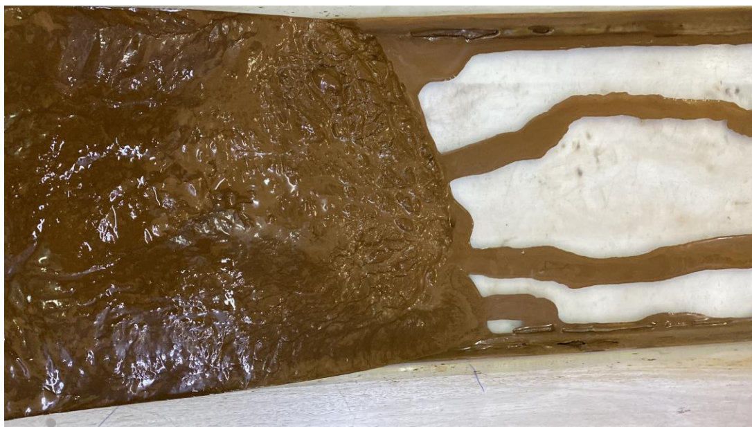
Figura 63 - Liberação de água durante o ensaio de flume .
