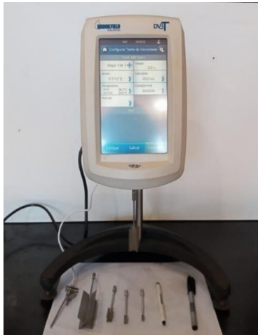
Figura 38 - Viscosímetro rotacional Brookfield DV3T.
