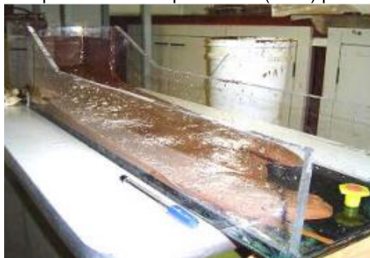
Figura 18 - Aparato utilizado por Osorio (2005) para flume test .
