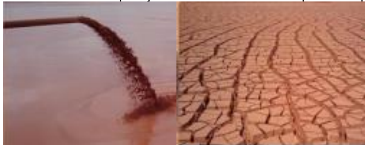
Figura 12 - Efeito de evaporação do material adensado quando disposto.
