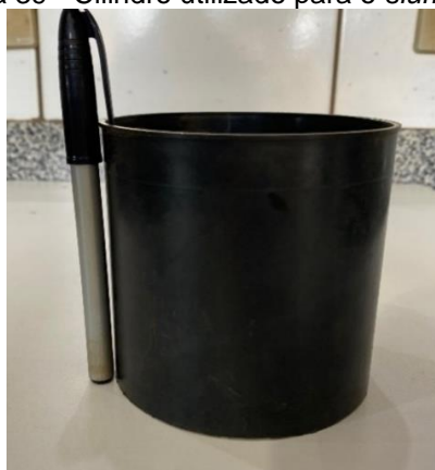
Figura 39 - Cilindro utilizado para o slump test .
