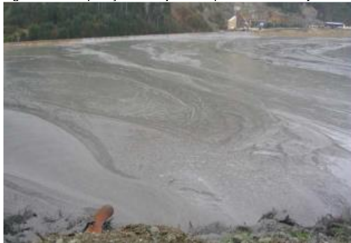
Figura 10 - Disposição de rejeitos espessados em Myra Falls.
