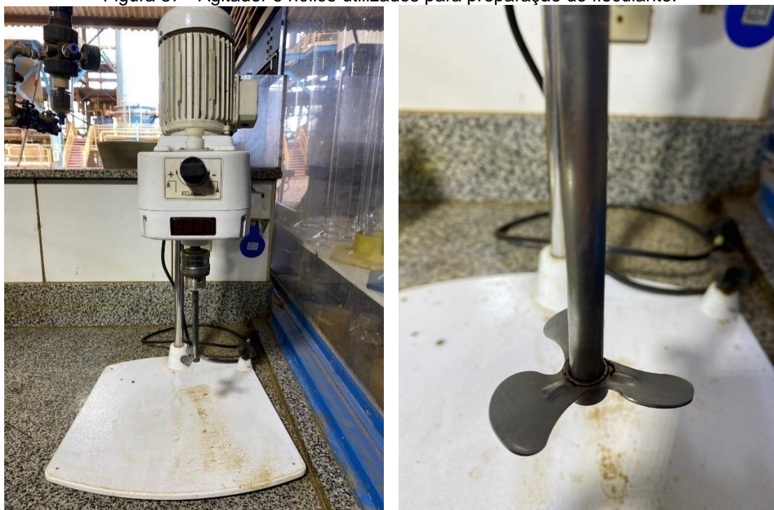
Figura 37 - Agitador e hélice utilizados para preparação do floculante.
