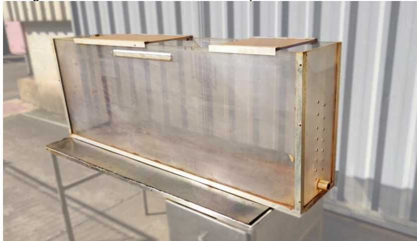
Figura 41 - Calha em acrílico utilizada para os ensaios de flume .
