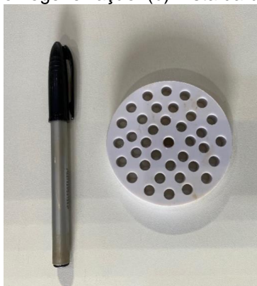
Figura 34 - (a) Haste utilizada para homogeneização. (b) Vista da base da haste
