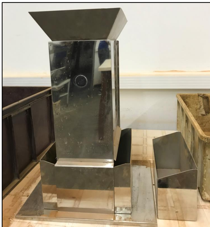
Figura 21: Divisor Jones usado na divisão do material particulado
