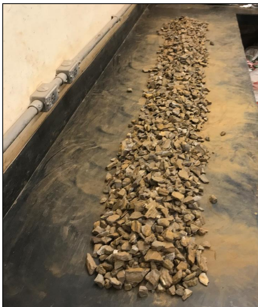
Figura 32: Fração extra grossa – construção de pilha alongada para a divisão do material
