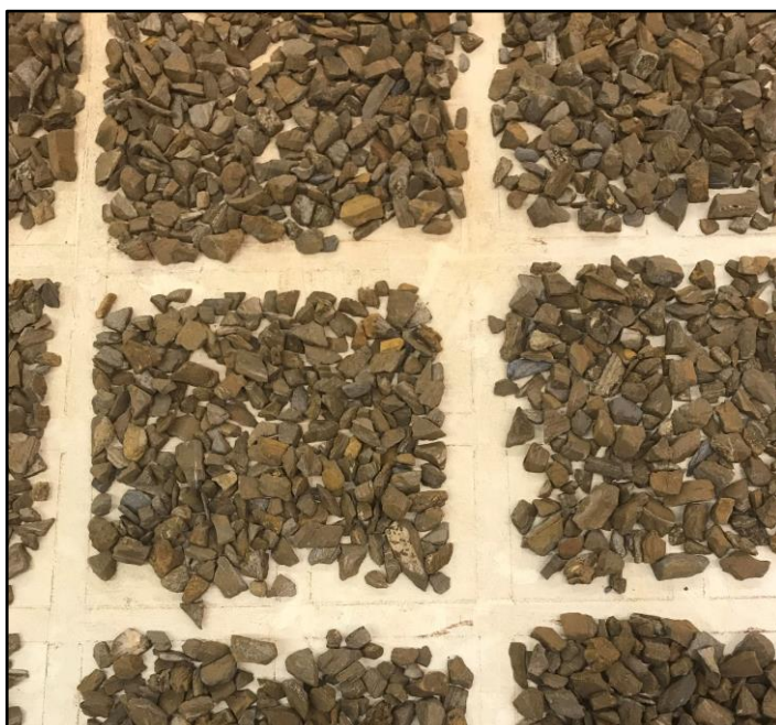
Figura 16: Detalhe fração grossa disposta sobre mesa com quadriculado 20 x 20 cm
