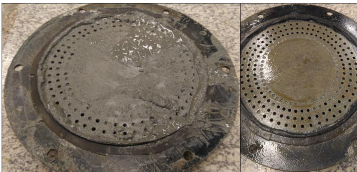
Figura 38 – Diafragma com diâmetro de aberturas de 1/4” após a execução do Ensaio A.
