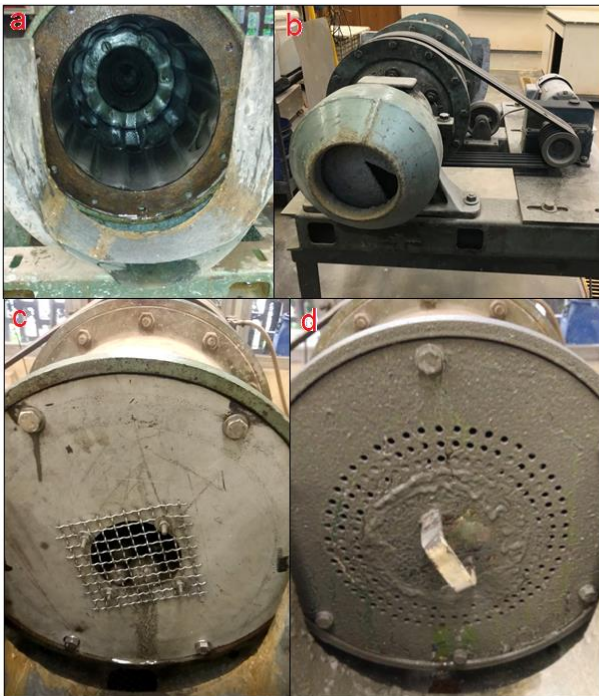
Figura 35 – Dispositivos do moinho contínuo: a) perfil do revestimento interno e calha de coleta; b) alimentador de tambor; c) descarga por overflow e d) descarga por diafragma.
