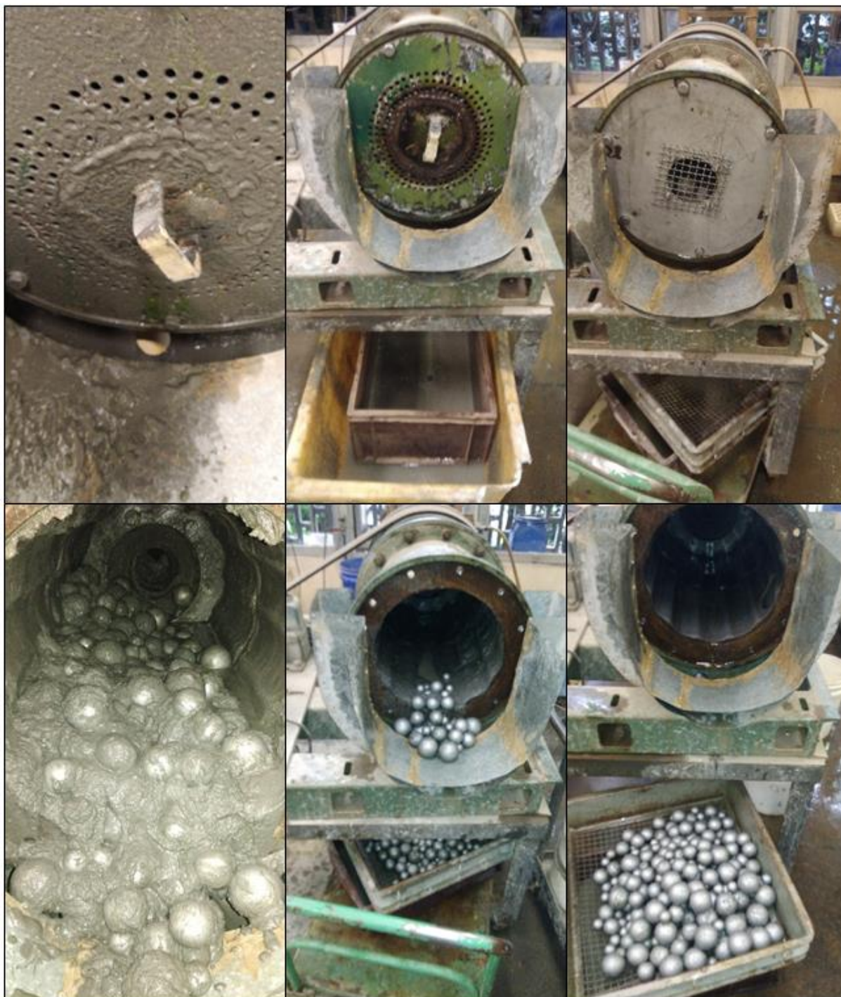
Figura 37 – Sequência de descarregamento e lavagem da carga interna do moinho.
