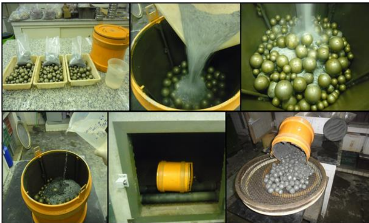
Figura 41 – Procedimento sequencial dos ensaios de moagem em batelada.
