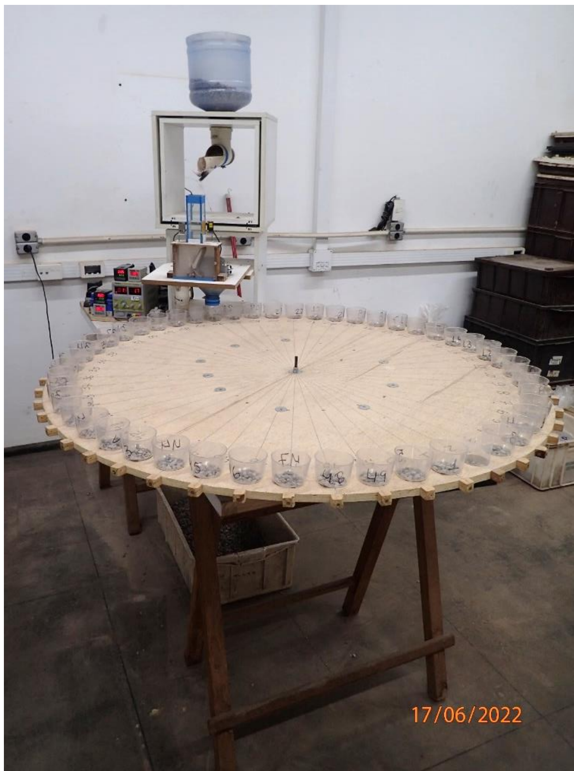
Figura 6 - Visão geral do Intrinsic Heterogeneity Tester
