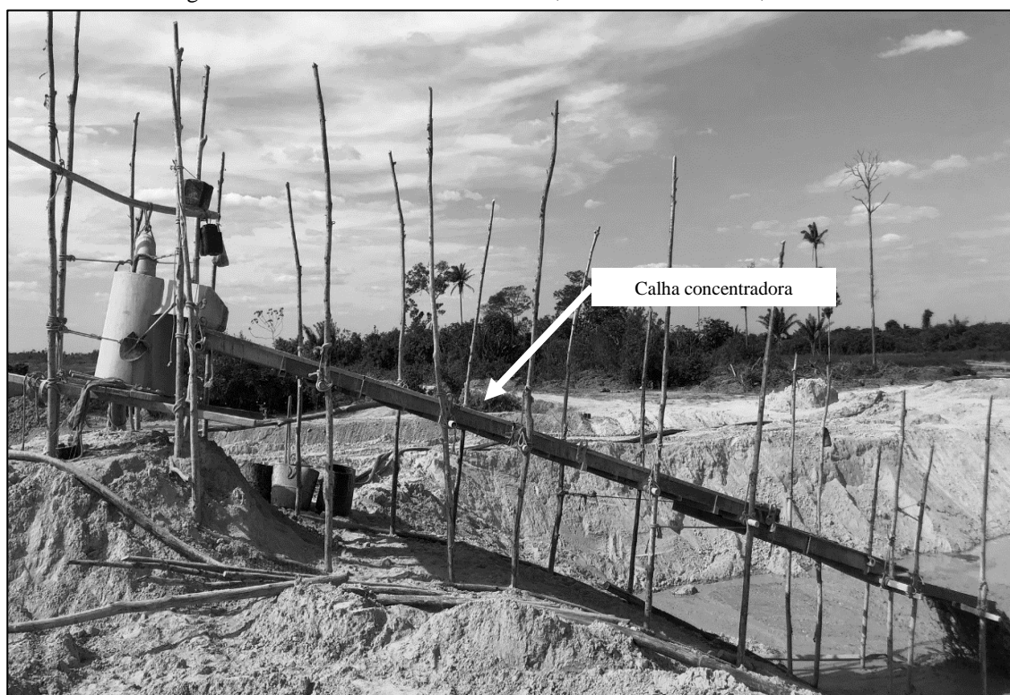
Figura 67 – Modelo calha concentradora, Peixoto de Azevedo, Mato Grosso
