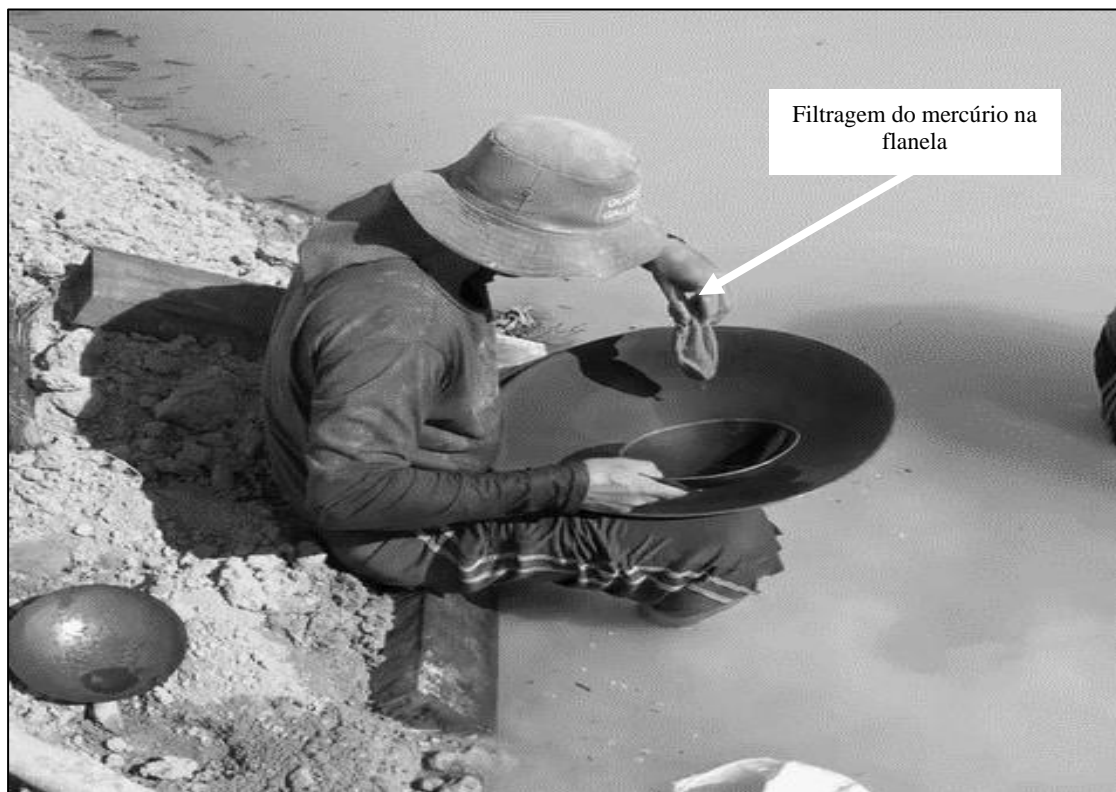
Figura 72 – Filtragem do mercúrio com o uso de flanela, Castelo dos Sonhos, Altamira, Pará
