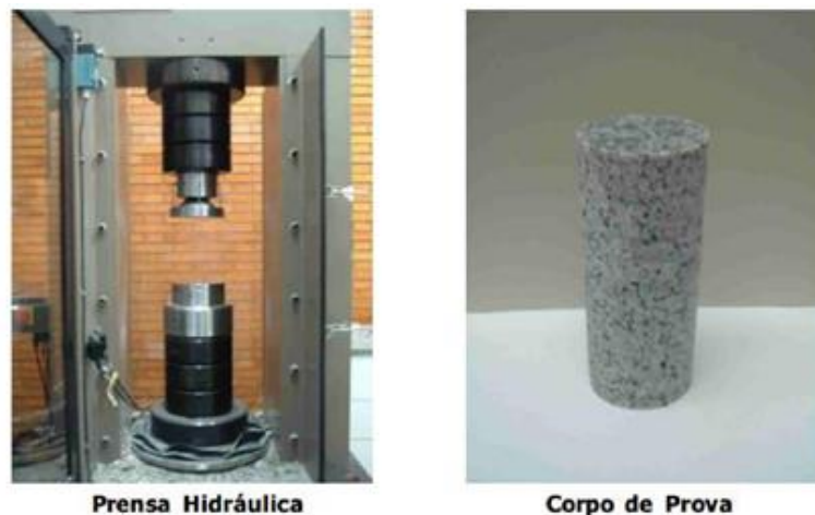
Figura 20: Elementos do ensaio de compressão uniaxial em rocha
