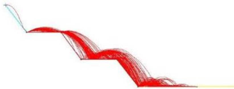
Figura 16: Análise da trajetória de queda de blocos em um talude
