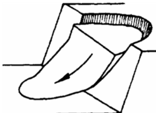
Figura 13: Ruptura em formato circular de talude
