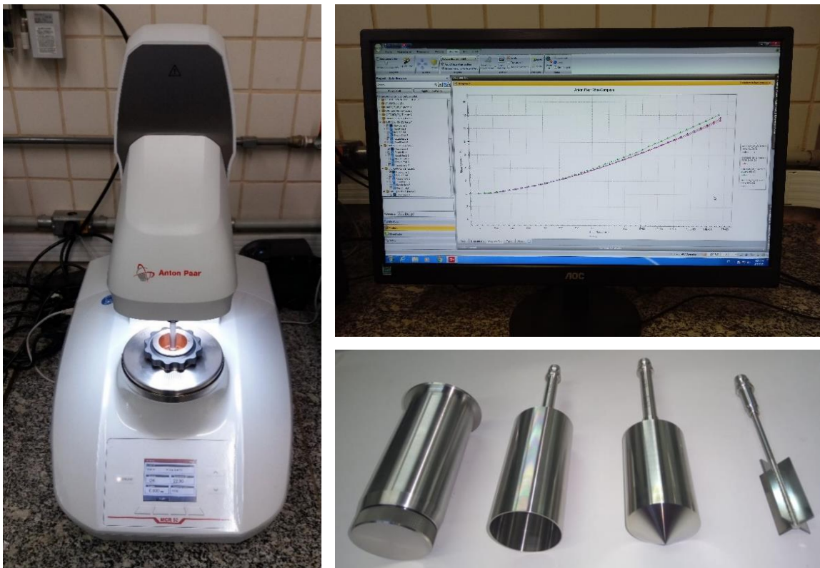
Figura 3.6 – Reômetro Anton Paar e geometrias dos tipos cilindros concêntricos e vane.
