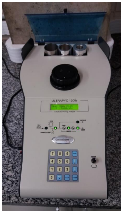
Figura 3.2 – Picnômetro a gás nitrogênio instalado no LFQI.
