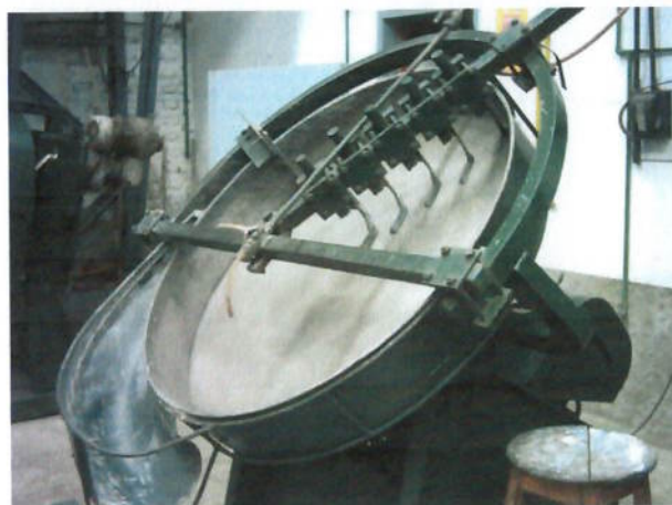
Figura 9 – Disco de pelotização utilizado nos ensaios
