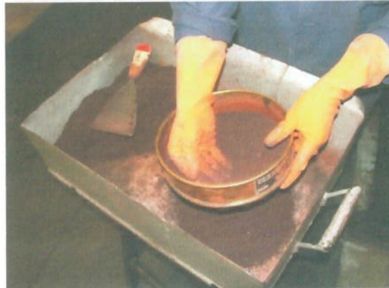
Figura 11 – Desagregação do material homogeneizado a pelotizar
