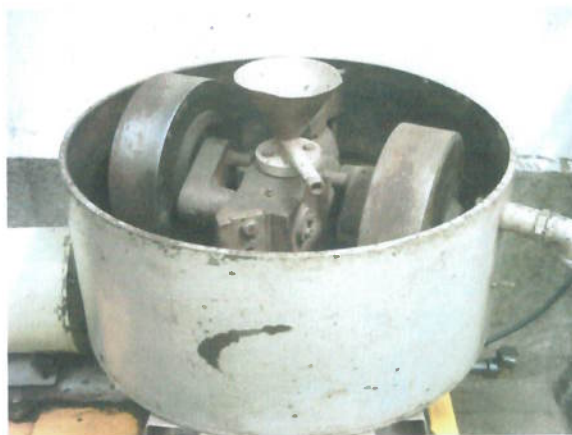
Figura 10 – Misturador de laboratório tipo Sympson Mix Müller
