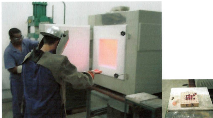
Figura 13 – Forno tipo mufla utilizado nos ensaios de choque térmico
