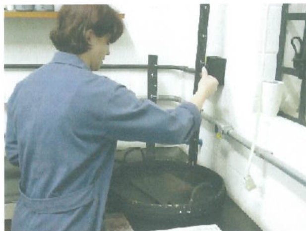
Figura 12 - Plataforma de aço usada para determinação do número de quedas
