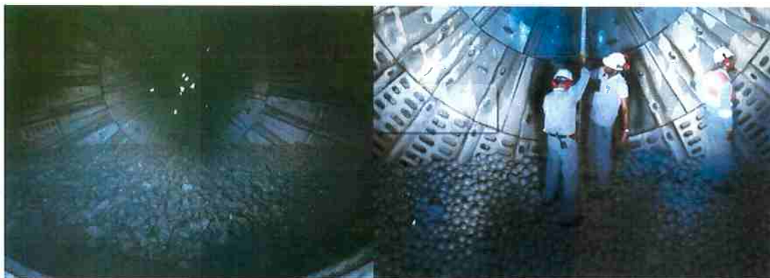
Figura 5.5 – Visão interna do SAG durante crash stop e grind ou Fonte: Arquivo do autor da pesquisa, 2014.
