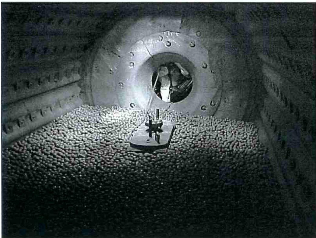
Figura 5.4 – Foto interna da câmara de bolas do moinho 025-MO-41
