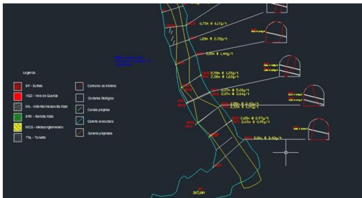
Figura 43 – Acompanhamento dos resultados a cada desmote (3,5 m)
