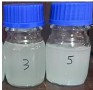
Figura 3.6. A esquerda, solução a 25°C e a direita, a solução aquecida a 60°C por 1 hora. Solução contendo 1,68 g/L \text{NaHCO}_3 ; 100 g/L de \text{NaCl} e 36,75 g/L de \text{CaCl}_2 \cdot 2\text{H}_2\text{O} .
