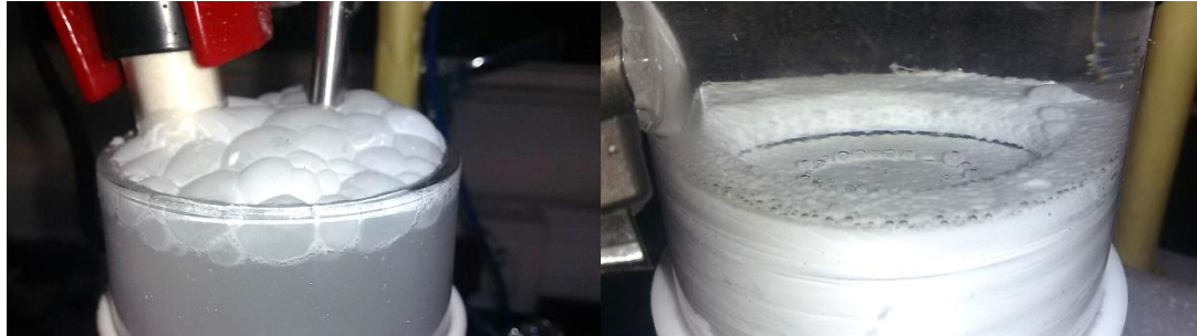
Figura 4.10. Formação de dióxido de carbono, principalmente na fase inicial do experimento
