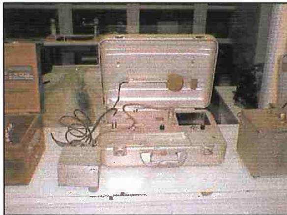
**FIGURA 49.** Modelo SSU II. Construído pela W.F. Sprengnether para a Philip Berger & Associates em 1976. Registrava 3 velocidades de partícula e sobre-pressão num filme que era revelado por luz fluorescente. Usado na década de 80. Massa: 12 kg.
