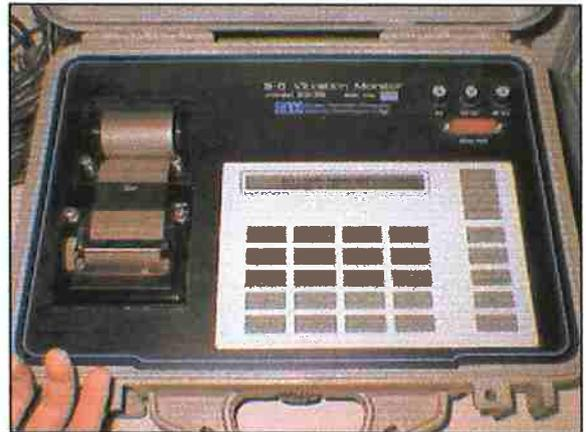
FIGURA 52. Detalhe do painel do Sinco S6, totalmente selado e com botões sensíveis ao toque. Todos os resultados podiam ser visualizados imediatamente e em seguida impressos em papel especial no próprio local de monitoramento.
