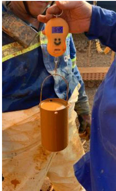
Figura 19. Balança Marcy com recipiente utilizados na determinação de densidade de polpas e porcentagem de sólidos
