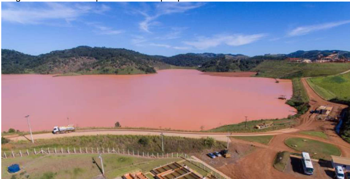
Figura 13. Bauxita disposta a úmido após processo de beneficiamento em Mirai-MG
