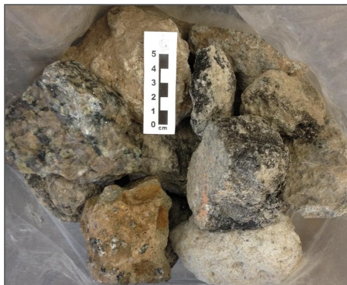
Figura 3.2 - Amostra de resíduo de concreto estudada composta por materiais pétreos e pasta de cimento porosa na superfície das partículas
