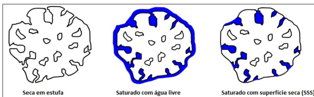
Figura 2.9 – Condição de umidade de agregados porosos
