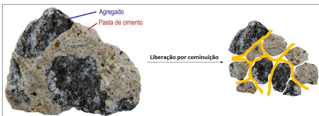
Figura 2.2 - Liberação por cominuição entre o agregado natural e a pasta de cimento
