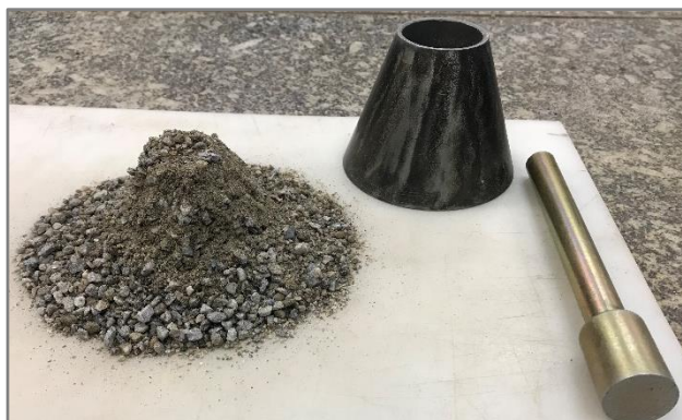
(b) Material sem umidade superficial em condição de SSS
