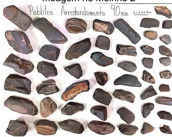
Figura 19 - Pebbles após 90 min de moagem no Moinho 2
