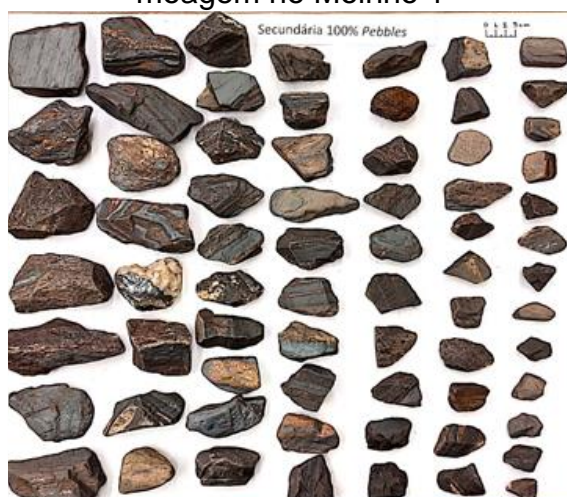
Figura 16 - Pebbles após 30 min de moagem no Moinho 1
