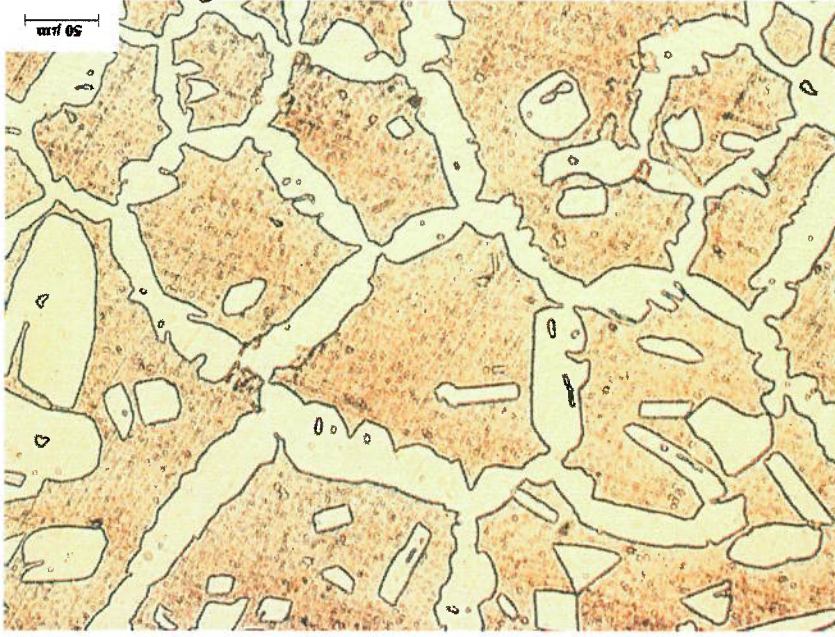
Figura 26: Amostra contendo fase sigma (850°C por 94h), ataque V2A, aumento de 200x, microscopia óptica. Vista de topo (plano X, vide figura 14).
