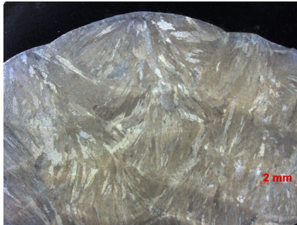
Figura 32: Representação da “almofada” do aço inoxidável austenítico AISI 308L.
