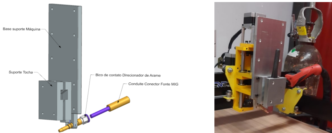
Figura 28: Base para fixação da tocha e alimentação de arame.
