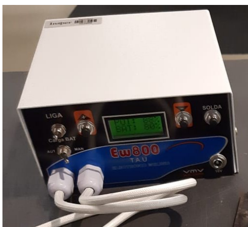
Figura 34: Fonte de soldagem Capacitiva marca: VMV e modelo: Ew800
