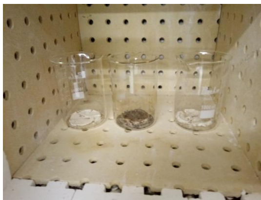
Figura 13 - Amostras que apresentaram diferença de coloração após a pirólise, mantiveram a diferença após calcinação à 350°C
