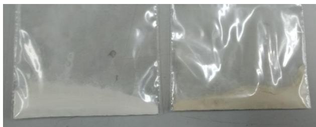
Figura 13 - Amostras que apresentaram diferença de coloração após a pirólise, mantiveram a diferença após calcinação à 350°C
