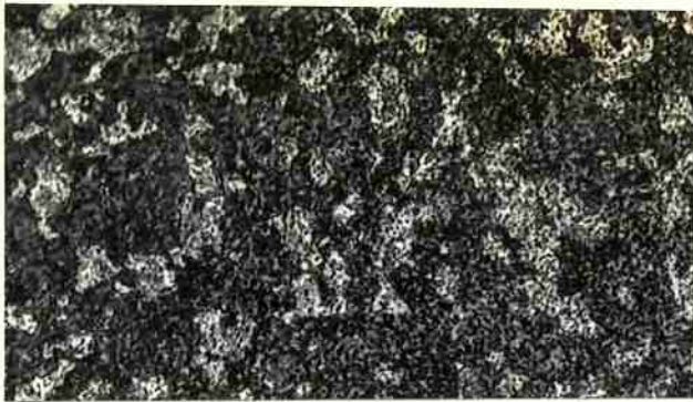
FIGURA 19 - Austenitizada a 750°C por 15 min e transformada a 700°C por 120 segundos. Grãos de perlita esferoidizada em matriz de martensita com carbonetos não dissolvidos. Ataque: Picral. Aumento: 500X.
