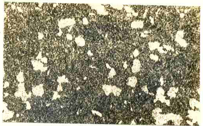
FIGURA 20 - Austenitizada a 750°C por 15 min e transformada a 660°C por 10 seg. Grãos de perlita esferoidizada em matriz de martensita com carbonetos não dissolvidos. Ataque: Picral. Aumento: 500X
