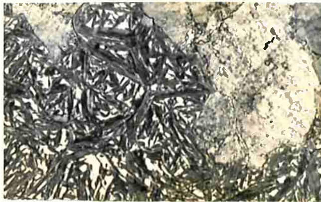
FIGURA 32 - Austenitizada a 890°C por 15 min e transformada a 660°C por 90 seg. Colônias de perlita fina em fundo de martensita e austenita retida. Ataque: Picral. Aumento: 1000X.
