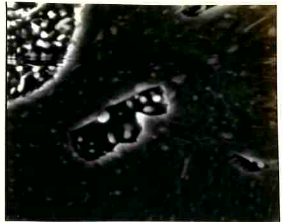
FIGURA 38 - Austenitizada a 750°C por 15 min e transformada a 700°C por 90 seg. Perlita esferoidizada em matriz de martensita com carb o netos não dissolvidos. Ataque: Ni tal 1%. Aumento: 5000X. MEV.
