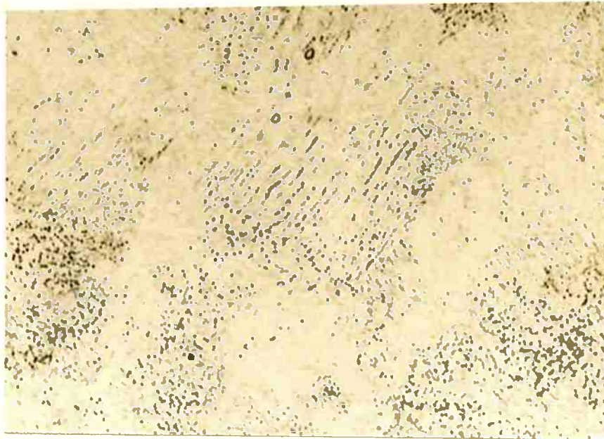
FIGURA 7 - Amostra A. Martensita com carbonetos esferoidizados não solubilizados. Ataque: Picral. 1000X.
