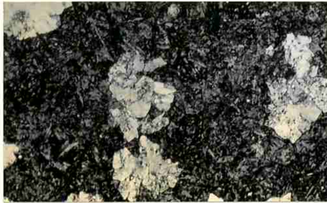
FIGURA 31 - Austenitizada a 890°C por 15 min e transformada a 660°C por 90 seg. Colônias de perlita fina em fundo de martensita e austenita retida. Ataque: Picral. Aumento: 500X.
