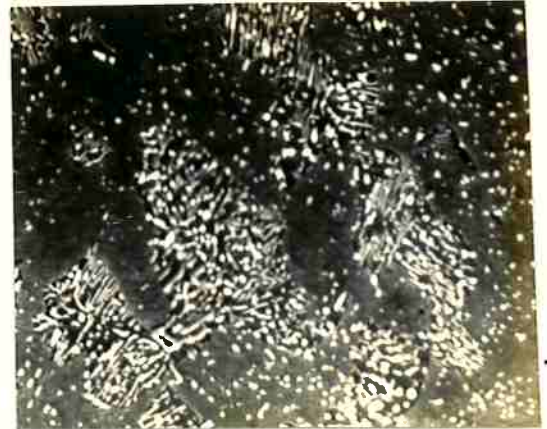
FIGURA 49 - Austenitizada a 750°C por 15 min e transformada a 660°C por 15 seg. Perlita esferoidizada fina e perlita lamelar em matriz de martensita com carbonetos não dissolvidos. Ataque: Nital 1%. A umento: 2000X. MEV.
