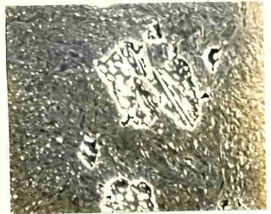
FIGURA 36 - Austenitizada a 750 °C por 15 min e transformada a 700 °C por 90 seg. Perlita esferoidizada em matriz de martensita com carbonetos não dissolvidos. Ataque: Nital 1%. Aumento: 2000X. MEV.
