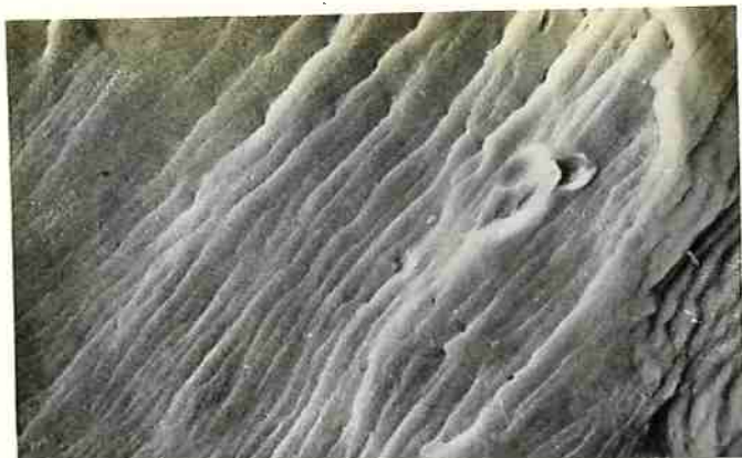
FIGURA 24 - Mesmo aspecto da figura 23, porém outra região. e=2\% . Sem ataque. MEV. Aumento - 6000 X.
