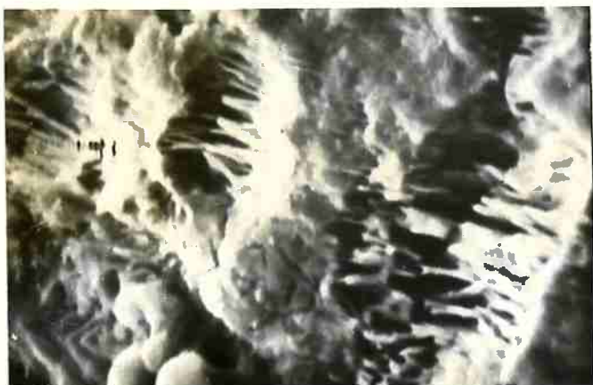
FIGURA 41 - Feixe de microtrincas, evidenciando as lamelas de cementita fraturadas. Perlita grossa. \epsilon=15\% . Ataque seletivo: nital 1%. MEV. Aumento - 2000 X.
