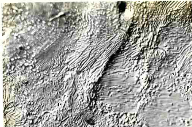
FIGURA 34 - Deformação intensa em contorno de colônia em superfície previamente polida e levemente atacada. \epsilon=5\% . Levemente atacada. MO. Contraste de interferência. Aumento - 1000 X.
