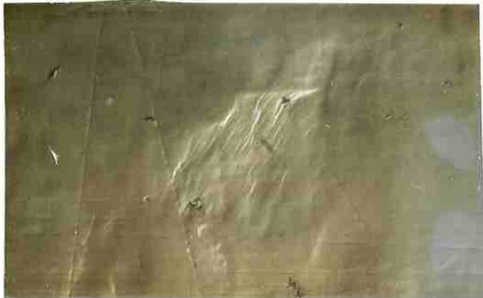
FIGURA 22 - Colônia de perlita grossa formando degraus de escorregamento em superfície previamente polida. e=2\% . Sem ataque. MO. Contraste de interferência. Aumento - 1000 X.
