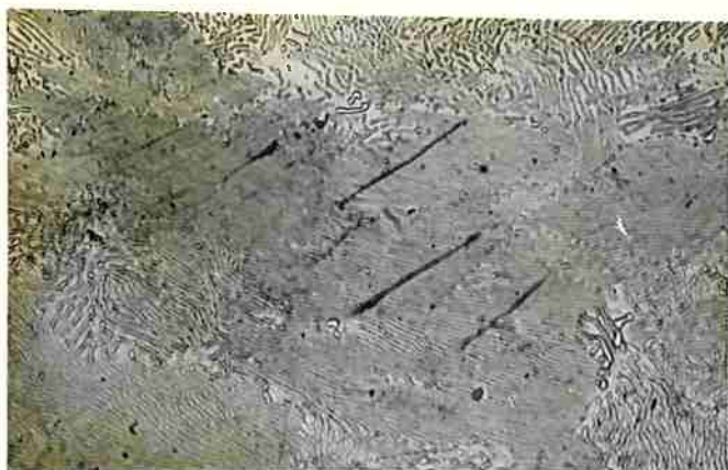
FIGURA 35 - Bandas de deformação, atravessando colônia de perlita grossa em feixes paralelos. e=5\% . Ataque: nital 1%. MO. Aumento - 500 X.
