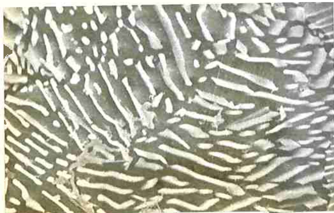
FIGURA 12 - Eutetóide Irregular em estrutura de perlita grossa Ataque seletivo. Nital 1%. MEV.Aumento 5000 X
