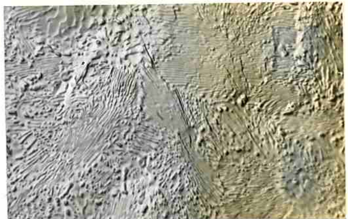
FIGURA 31 - Degraus formados em superfície polida e levemente atacada. Nota-se a coincidência de orientações dos degraus e da colônia. \epsilon=5\% . Levemente atacada. MO. Contraste de interferência. Aumento - 1000 X.
