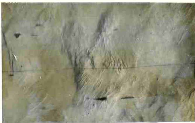
FIGURA 29 - Colônia de perlita grossa formando degraus de escorregamento em superfície previamente polida. Nota-se uma colônia que se deforma como um empilhamento de cartas orientada a 90^\circ com o eixo de tração. Este coincide com o risco de polimento. e=5\% . Sem ataque. MO. Contraste de interferência. Aumento - 1000 X.
