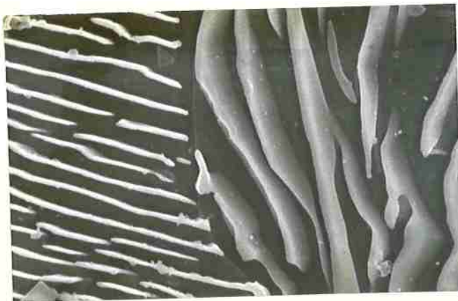
FIGURA 16 - Contorno de colônias de perlita grossa. Nota-se a continuidade da ferrita e o contorno de grão ferrítico. Ataque seletivo Nital 1%. MEV. Aumento 10000 X.
