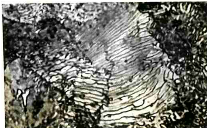
FIGURA 38 - Banda de deformação em colônia de perlita grossa. Nota-se o efeito da orientação sobre a propagação da banda. \epsilon=1\% . Ataque: nital 1%. MO. Aumento - 1000 X.
