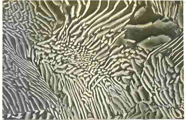
FIGURA 13 - Eutetóide irregular em estrutura de perlita fina. Ataque seletivo. Nital 1%. MEV Aumento - 6000 X.
