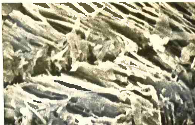
FIGURA 43 - Banda de deformação em colônia de perlita fina. Nota-se o rompimen to das lamelas de cementita. \epsilon=10\% . Ataque seletivo: nital 1%. MEV. Au mento - 6000 X.
