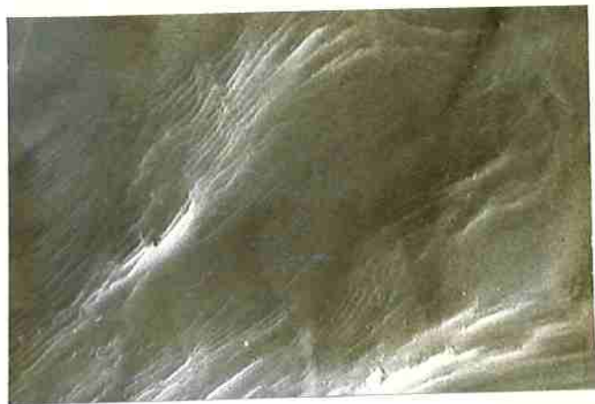
FIGURA 26 - Mesmo aspecto da figura 25, porém outra região. e=2\% . Sem ataque. MEV. Aumento - 10000 X.
