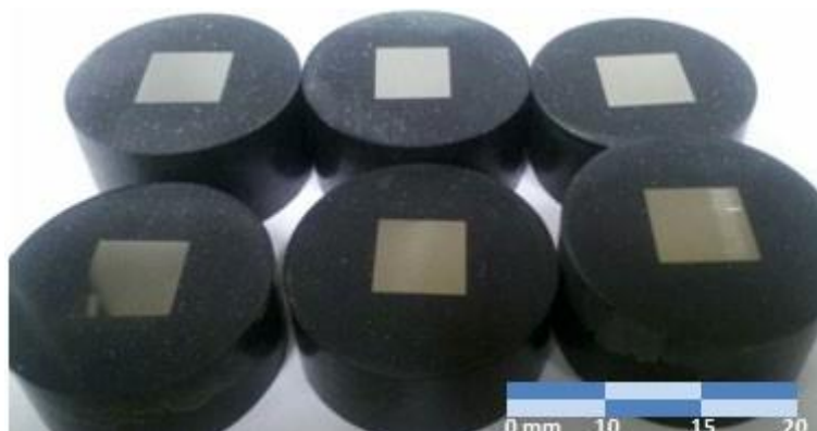
Figura 36 – Amostras embutidas em resina epóxi, lixadas e prontas para os ensaios.
