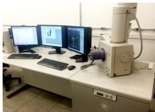
Figura 37 - Microscópio óptico (a) Olympus BX60M e (b) microscópio eletrônico de varredura Philips XL-30 utilizados para as análises microestruturais.
