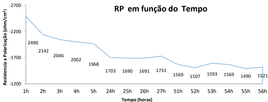
Figura 63 – Variação da Resistência de Polarização Linear em função do tempo de imersão do aço ASTM A1018 em solução aquosa com 3,0% de CLR.
