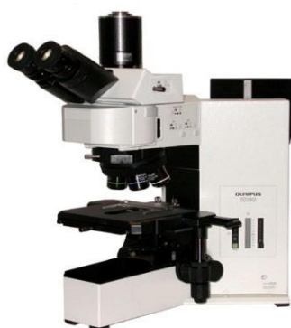
Figura 37 - Microscópio óptico (a) Olympus BX60M e (b) microscópio eletrônico de varredura Philips XL-30 utilizados para as análises microestruturais.
