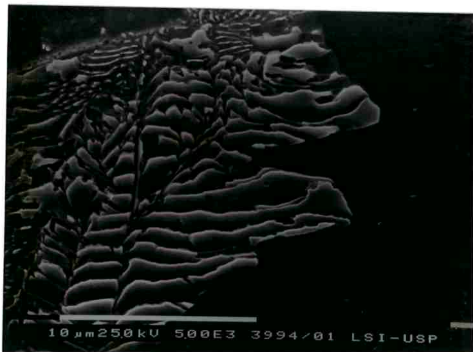
Figura 5.23 Micrografia do aço 1 mostrando a ocorrência de precipitação descontínua de (Cr, Fe)_2N , após tratamento térmico de envelhecimento a 960^\circ\text{C} por 6 minutos seguido de resfriamento em água. Os nitretos são lamelares, como mostra a microestrutura. Microscopia eletrônica de varredura com elétrons secundários. Ataque: V2A-Beize.
