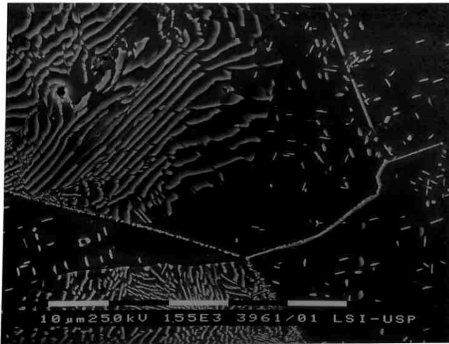
Figura 5.24 Micrografia do aço 1 mostrando a ocorrência de precipitação contínua e descontínua de (Cr, Fe)_2N , após tratamento térmico de envelhecimento a 1040^{\circ}C por 1 hora seguido de resfriamento em água. Microscopia eletrônica de varredura com elétrons secundários. Ataque: V2A-Beize.
