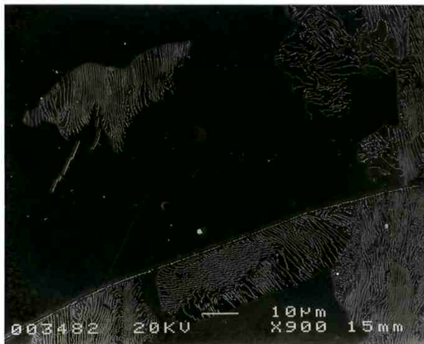
Figura 5.52 Microestrutura do aço 4 na zona austenítica, após tratamento térmico de envelhecimento a 900°C por 1 hora seguido de resfriamento em água. Precipitação descontínua de nitretos de cromo. Microscopia eletrônica de varredura com elétrons secundários. Ataque: V2A-Beize.
