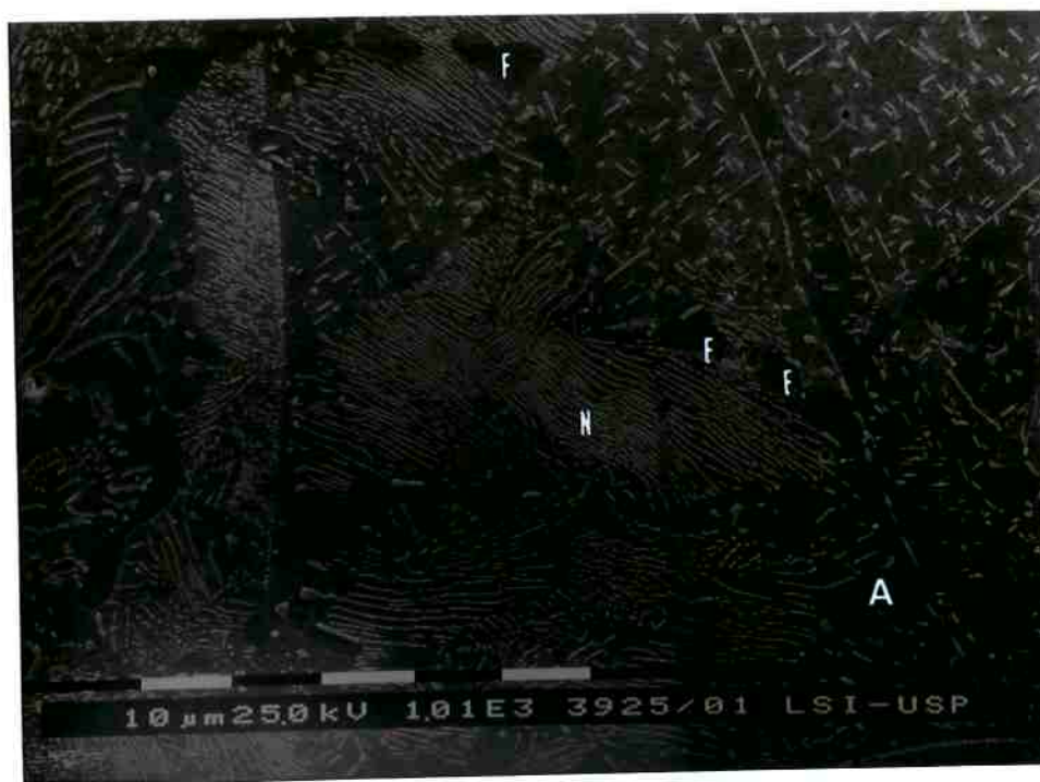
Figura 5.27 Formação de ferrita junto aos nitretos de cromo que precipitaram de maneira descontínua na amostra do aço 1 envelhecida a 1000°C por 10 horas. A indica austenita, N indica o nitreto de cromo e F indica a ferrita. Microscopia eletrônica de varredura com elétrons secundários. Ataque: V2A-Beize.
