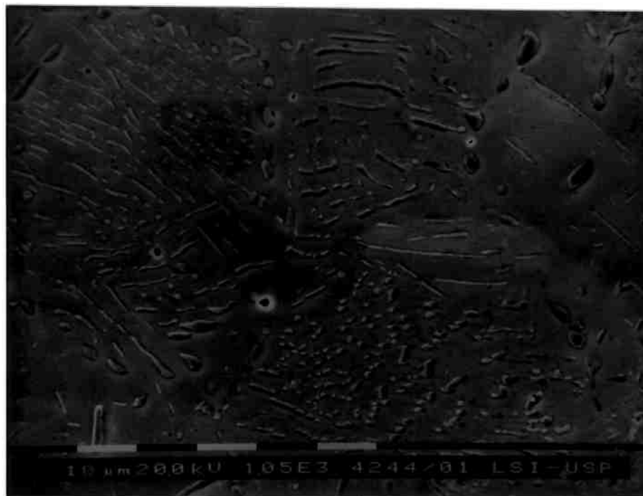
Figura 5.25 Micrografia do aço 1 mostrando coalescimento de (Cr, Fe)_2N que precipitou de maneira descontínua, após tratamento térmico de envelhecimento a 1050^{\circ}C por 100 horas seguido de resfriamento em água. Microscopia eletrônica de varredura com elétrons secundários. Ataque: V2A-Beize.
