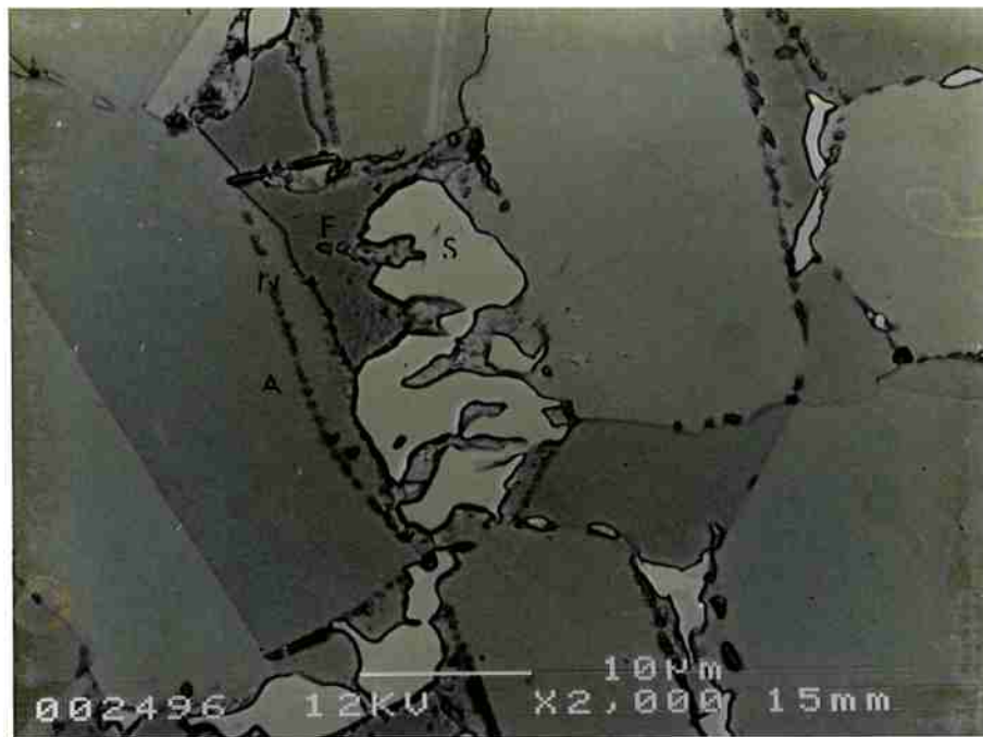
Figura 5.66 Microestrutura do aço 4 na zona dúplex, após tratamento térmico de envelhecimento a 860°C por 10 horas seguido de resfriamento em água. A indica austenita, F indica ferrita, N indica o nitreto de cromo e S indica a fase sigma. Microscopia eletrônica de varredura utilizando retroespalhados. Ataque: V2A-Beize.
