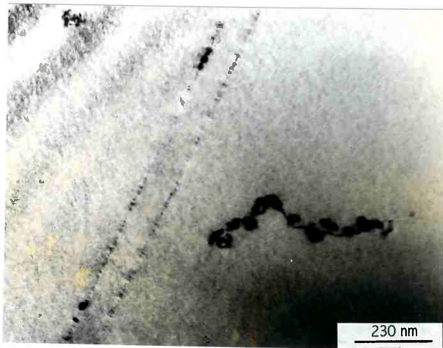
Figura 5.21 Precipitação de (Cr,Fe)_2N em uma discordância e em uma macla na amostra do aço 1 , após tratamento térmico de envelhecimento a 800°C por 3 minutos seguido de resfriamento em água. Microscopia eletrônica de transmissão.
