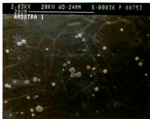
Figura 4.1 Microestrutura do material conforme recebido. Microscopia eletrônica de varredura com elétrons secundários. Ataque: V2A-Beize.
