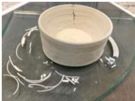
Figura 50 - Miniatura de cuba impressa - detalhe para placa de vidro menor sobre a mesa de alumínio, a saia já seca ao redor da peça e a linha de junção aparente na parte de trás da peça.
