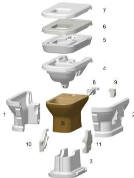
Figura 5 – Moldes de gesso para a colagem de barbotina de uma bacia sanitária: B - Bacia Sanitária; 1 e 2 - Laterais; 3 - Parte inferior; 4 - Parte Superior; 5 a 7 – Argola; 8 a 11 - Tacelos.
