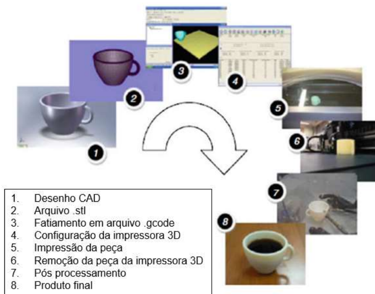
Figura 9 - 8 passos básicos para a confecção de uma peça via manufatura aditiva.
