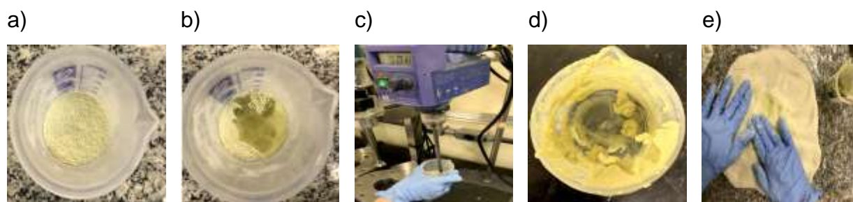
Figura 40 - Preparação da pasta com bentonita a) Pesagem da bentonita b) Adição da água no recipiente de bentonita c) Agitação mecânica d) Pasta de bentonita e água e) Mistura manual da pasta de bentonita na pasta cerâmica.
