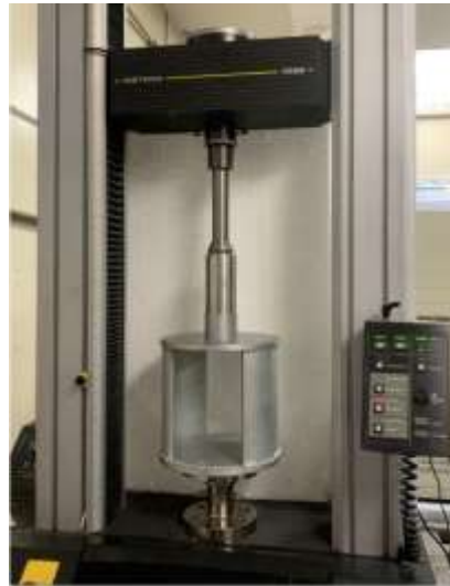
Figura 17 - Ensaio de Benbow & Bridgwater com máquina Instron.
