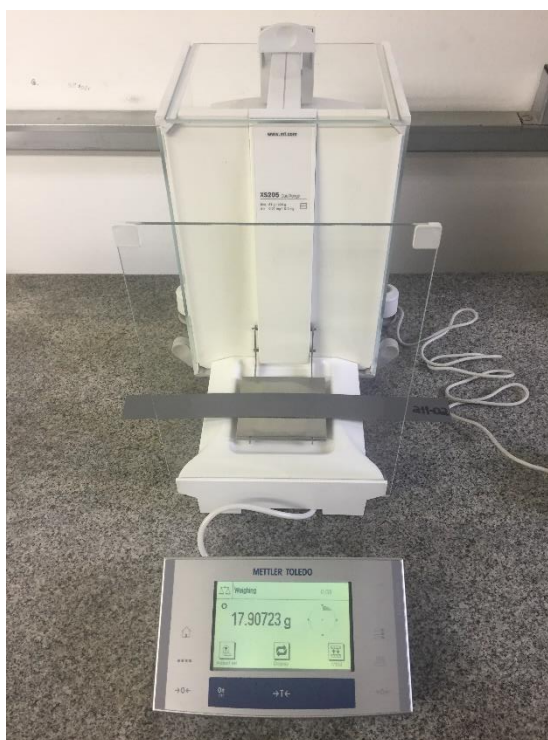
Figura 17: Determinação da massa das amostras de aço silício GO efetuada antes da realização dos ensaios no Quadro de Epstein. Fonte: O Autor.
