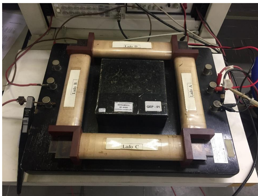
Figura 18: Quadro de Epstein do Laboratório de Metrologia Elétrica (LME) do IPT – Instituto de Pesquisas Tecnológicas do Estado de São Paulo. Fonte: O Autor.
