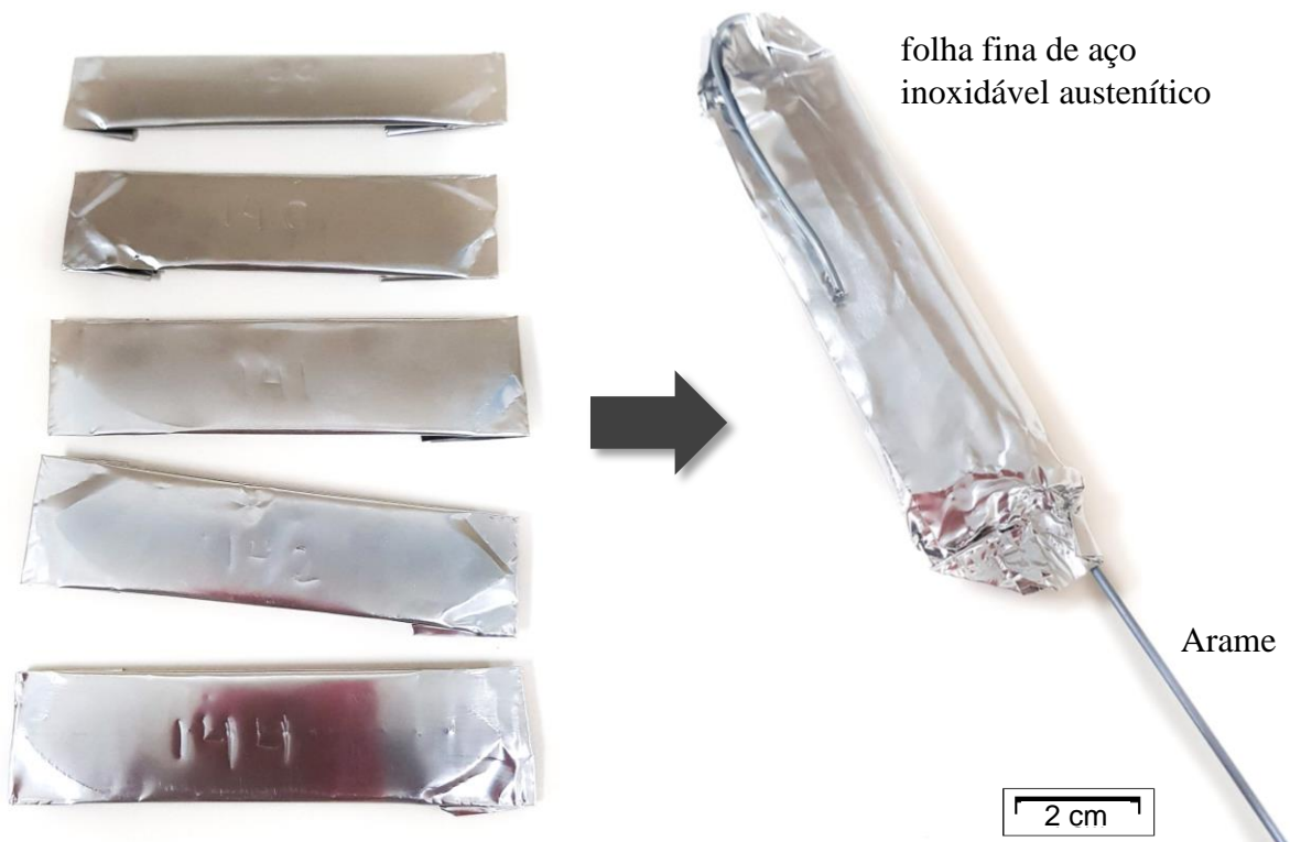
Figura 32 – Fotografia das amostras embaladas para tratamento térmico de solubilização
