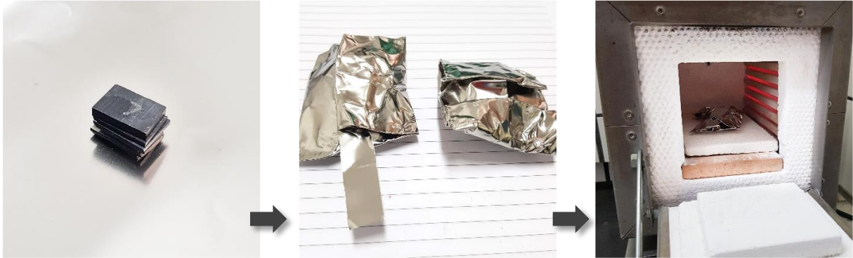
Figura 33 – Fotografia das amostras embaladas para tratamento térmico de envelhecimento
