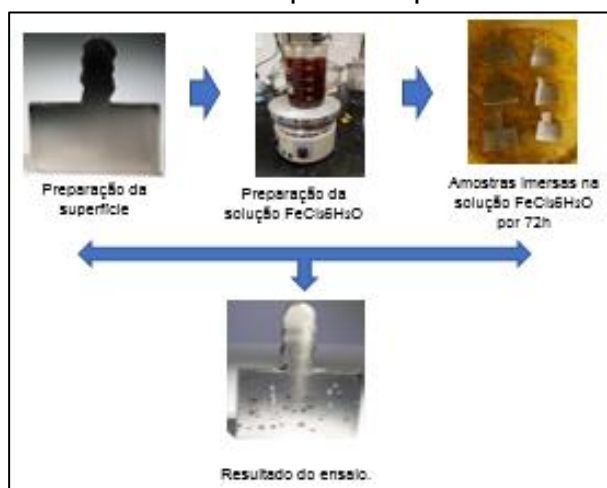
Figura 4-3 Figura ilustrativa do ensaio de corrosão ASTM G48 prática A para manufatura aditiva do ER308L realizado a 22± 2°C.
