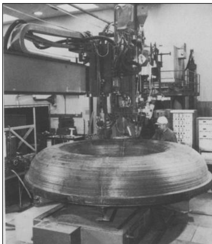
Figura 2-5. Fabricação de meio toróide mediante o método de rotação vertical [21].
