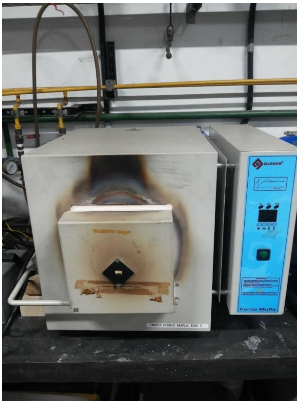
Figura 11: Forno mufla utilizado na medição do teor de cinzas do redutor.
