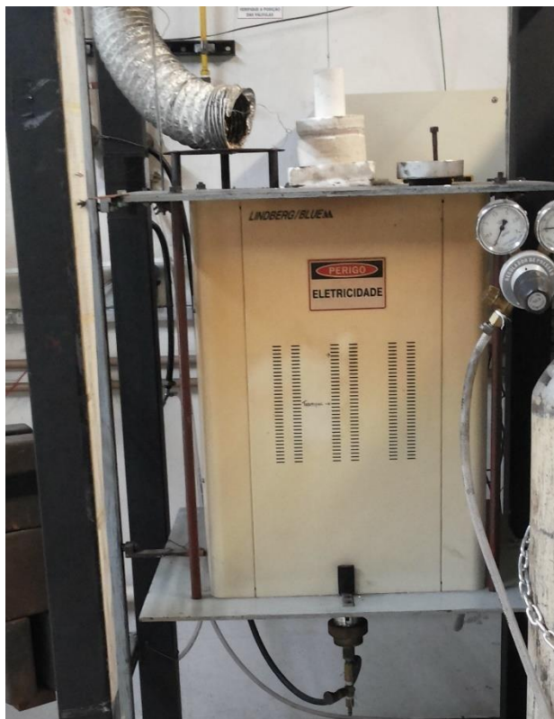
Figura 12: Forno tubular vertical utilizado para a medição do teor de voláteis dos redutores e para os ensaios de redução.
