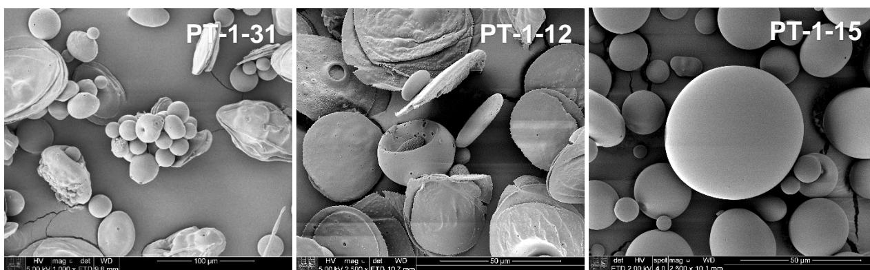
Figura 27 - Micrografias com aumento de 2.500x das amostras PT-1-31, PT-1-12 e PT-1-15 para análise dos efeitos da alteração da proporção AA/FC sobre a estrutura morfológica das microcápsulas
