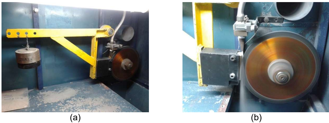
Figura 41 – Fotografias do tribômetro Roda de Borracha utilizado nos ensaios: (a) visão geral do equipamento e (b) visão frontal da roda de borracha na realização de ensaio.
