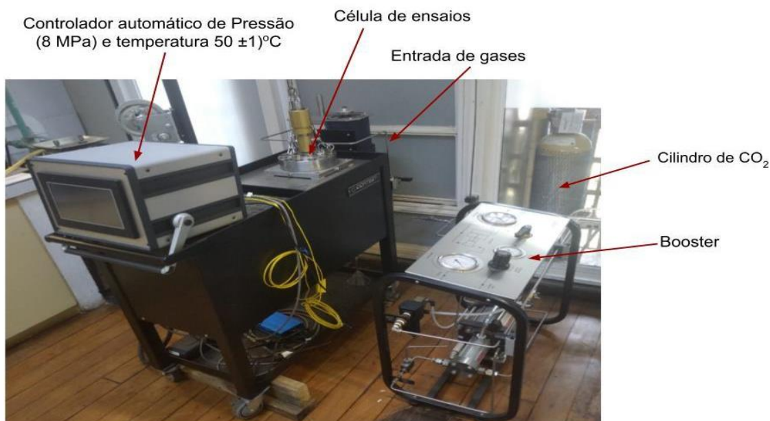
Figura 4.13 –Autoclave utilizada para a realização dos ensaios de perda de massa.
