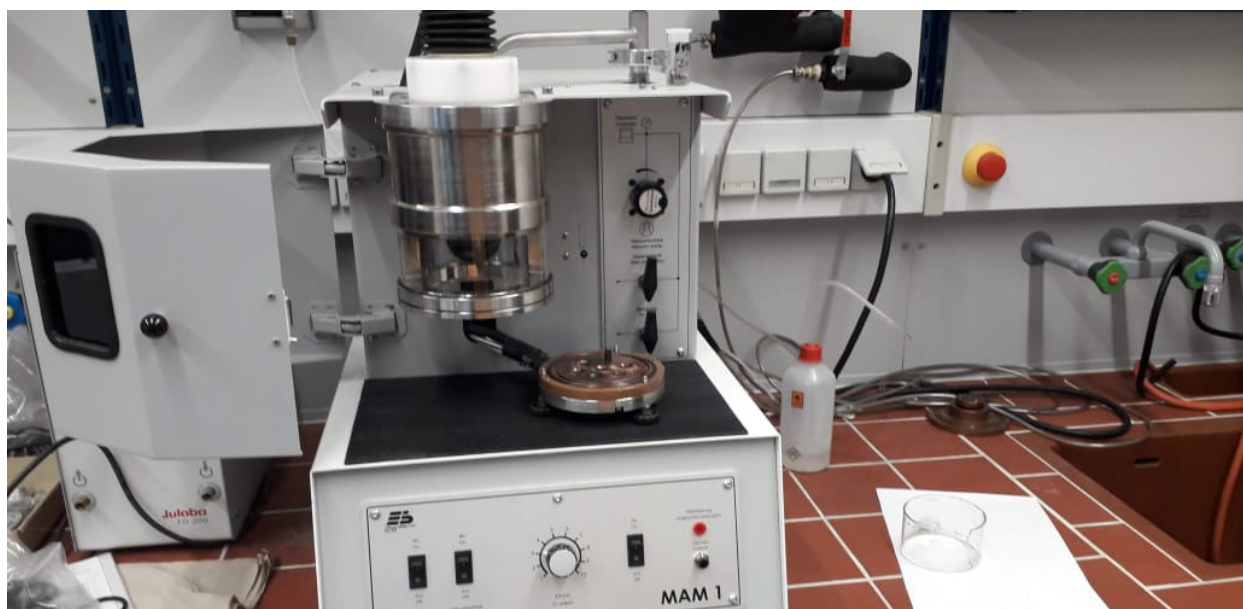
Figura 3.6: Forno a arco voltaico utilizado na Universidade de Viena para a síntese das composições. Fonte: acervo pessoal do autor.
