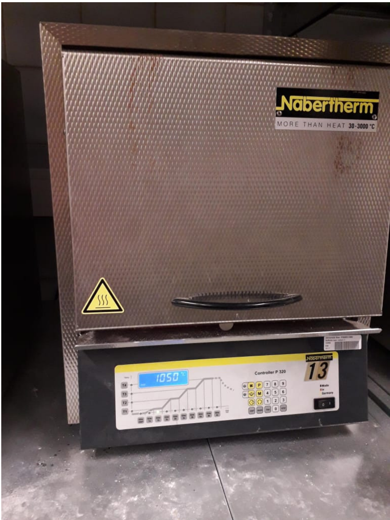
Figura 3.5: Forno utilizado na Universidade de Viena para o tratamento térmico. Fonte: acervo pessoal do autor.
