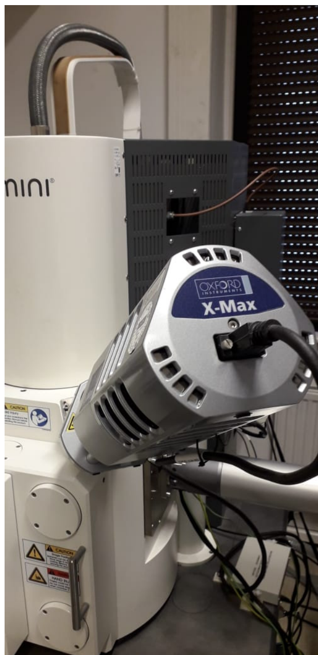
Figura 3.2: MEV com EDS acoplado utilizado na Universidade de Viena. Fonte: acervo pessoal do autor.
