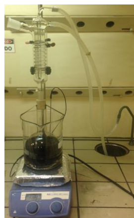
Figura 25 – (a) Fotografia da reação de redução do GO com borohidreto de sódio, em refluxo. (b) rGO depois da redução química com \text{NaBH}_4 e após o processo de filtragem.
