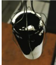
Figura 24 – Cadinho depois de ser retirado do forno após o processo de redução térmica do GO.
