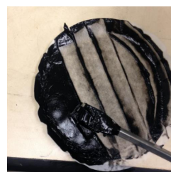
Figura 25 – (a) Fotografia da reação de redução do GO com borohidreto de sódio, em refluxo. (b) rGO depois da redução química com \text{NaBH}_4 e após o processo de filtragem.
