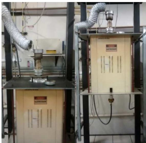
Figura 22 – Forno vertical utilizado para os choques térmicos.
