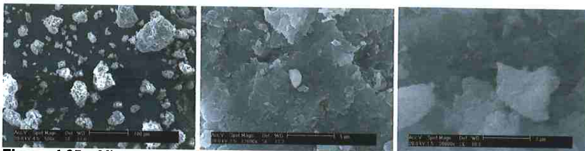
Figura 4.85 - Microscopia eletrônica de varredura da argila E após tratamento com CTAC 50, com aumentos de 500, 12000 e 30000 vezes (escalas de 100, 5 e 2 µm, respectivamente).
