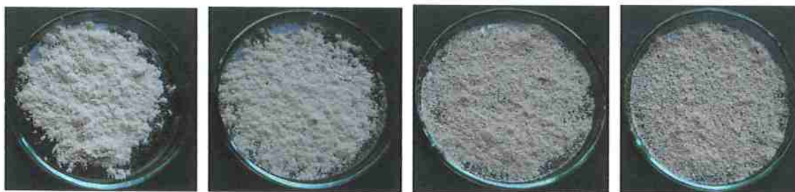
Figura 4.2 - Variação da cor conforme temperatura de tratamento da argila A, natural, 110 °C, 350 °C e 500 °C (da esquerda para a direita).
