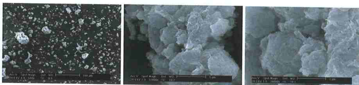
Figura 4.92 - Microscopia eletrônica de varredura da argila B após tratamento com Praepagen, com aumentos de 500, 12000 e 30000 vezes (escalas de 100, 5 e 2 µm, respectivamente).
