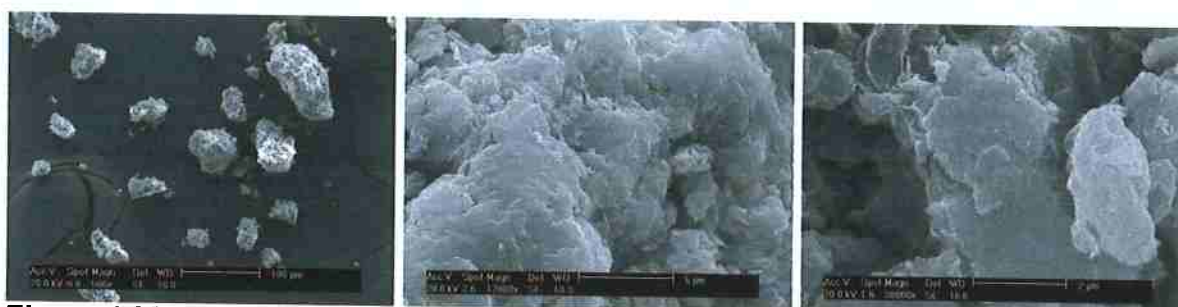
Figura 4.90 - Microscopia eletrônica de varredura da argila E após tratamento com Dodigen, com aumentos de 500, 12000 e 30000 vezes (escalas de 100, 5 e 2 µm, respectivamente).
