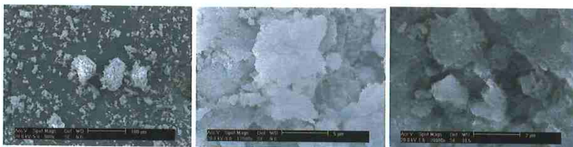
Figura 4.77 - Microscopia eletrônica de varredura da argila B, no estado natural, com aumentos de 500, 12000 e 30000 vezes (escalas de 100, 5 e 2 µm, respectivamente).
