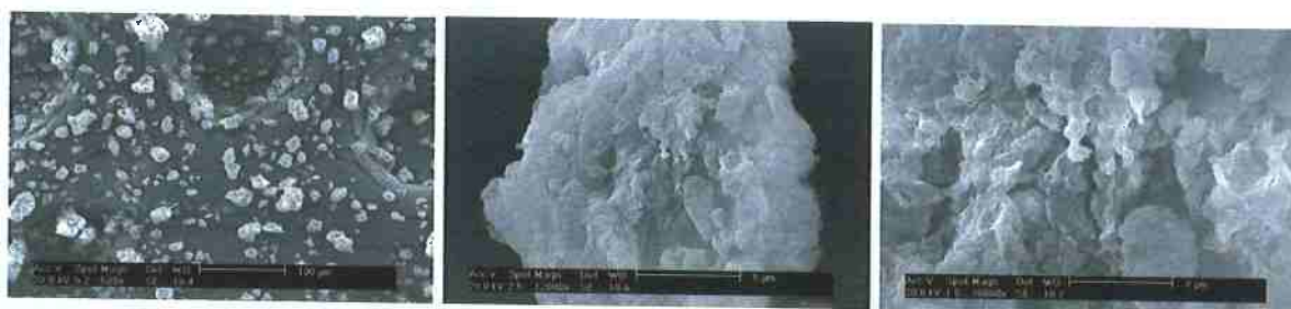
Figura 4.81 - Microscopia eletrônica de varredura da argila A após tratamento com CTAC 50, com aumentos de 500, 12000 e 30000 vezes (escalas de 100, 5 e 2 \mu\text{m} , respectivamente).
