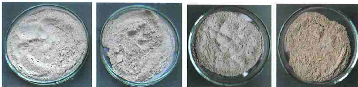
Figura 4.3 - Variação da cor conforme temperatura de tratamento da argila B, natural, 110 °C, 350 °C e 500 °C (da esquerda para a direita).
