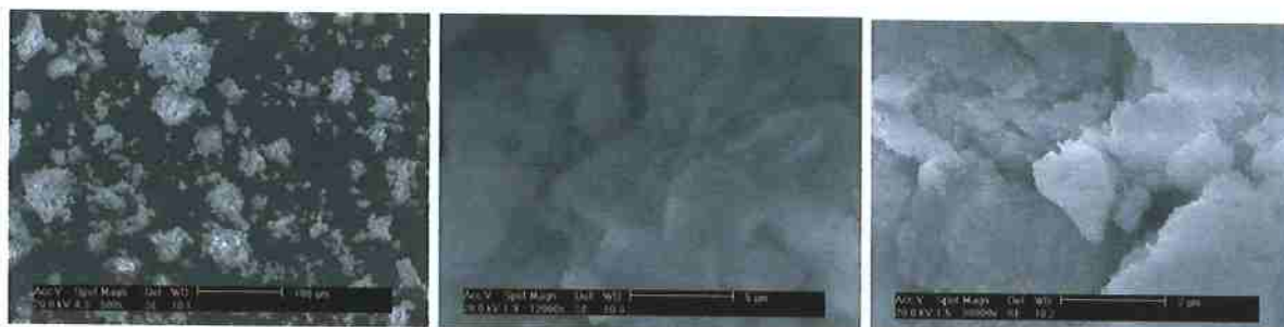
Figura 4.79 - Microscopia eletrônica de varredura da argila D, no estado natural, com aumentos de 500, 12000 e 30000 vezes (escalas de 100, 5 e 2 µm, respectivamente).
