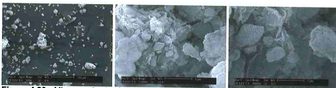
Figura 4.89 - Microscopia eletrônica de varredura da argila D após tratamento com Dodigen, com aumentos de 500, 12000 e 30000 vezes (escalas de 100, 5 e 2 µm, respectivamente).
