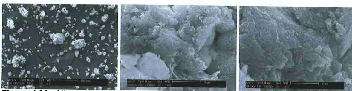
Figura 4.86 - Microscopia eletrônica de varredura da argila A após tratamento com Dodigen, com aumentos de 500, 12000 e 30000 vezes (escalas de 100, 5 e 2 µm, respectivamente).
