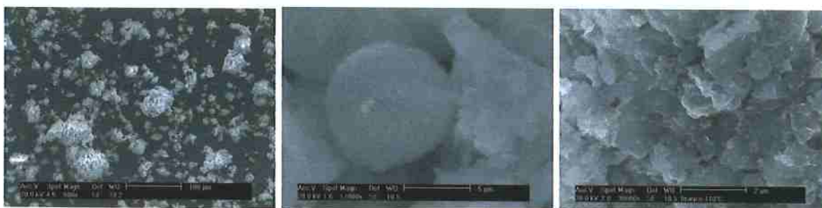
Figura 4.76 - Microscopia eletrônica de varredura da argila A, no estado natural, com aumentos de 500, 12000 e 30000 vezes (escalas de 100, 5 e 2 µm, respectivamente).
