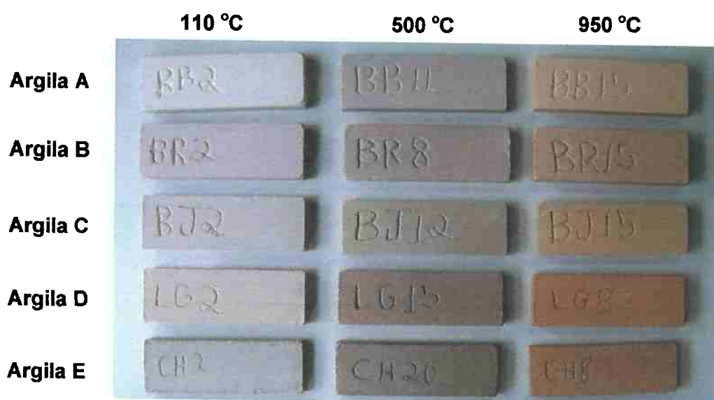
Figura 4.96 - Corpos de prova das argilas A a E, secos a 110 °C e queimados a 500 e 950 °C.
