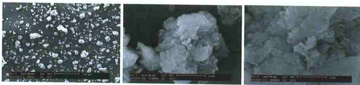
Figura 4.82 - Microscopia eletrônica de varredura da argila B após tratamento com CTAC 50, com aumentos de 500, 12000 e 30000 vezes (escalas de 100, 5 e 2 µm, respectivamente).
