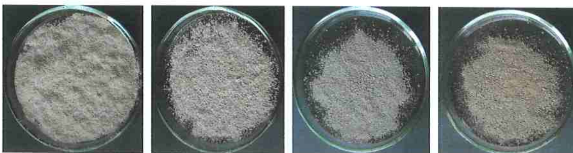
Figura 4.6 - Variação da cor conforme temperatura de tratamento da argila E, natural, 110 °C, 350 °C e 500 °C (da esquerda para a direita).
