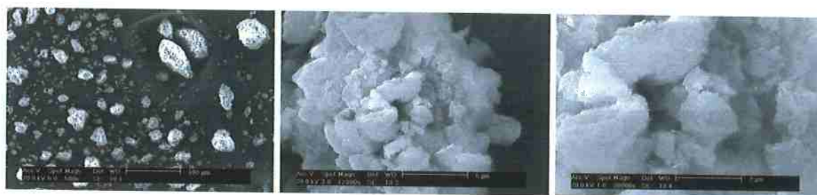
Figura 4.94 - Microscopia eletrônica de varredura da argila D após tratamento com Praepagen, com aumentos de 500, 12000 e 30000 vezes (escalas de 100, 5 e 2 \mu\text{m} , respectivamente).
