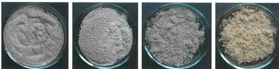
Figura 4.4 - Variação da cor conforme temperatura de tratamento da argila C, natural, 110 °C, 350 °C e 500 °C (da esquerda para a direita).
