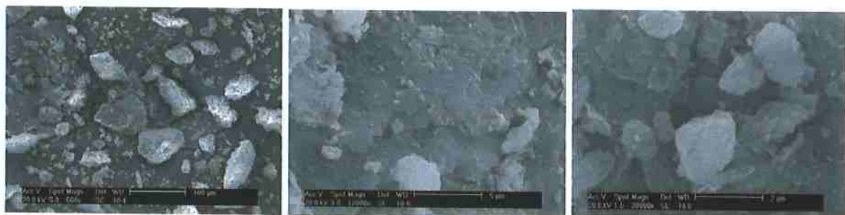
Figura 4.80 - Microscopia eletrônica de varredura da argila E, no estado natural, com aumentos de 500, 12000 e 30000 vezes (escalas de 100, 5 e 2 µm, respectivamente).
