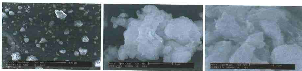
Figura 4.83 - Microscopia eletrônica de varredura da argila C após tratamento com CTAC 50, com aumentos de 500, 12000 e 30000 vezes (escalas de 100, 5 e 2 µm, respectivamente).
