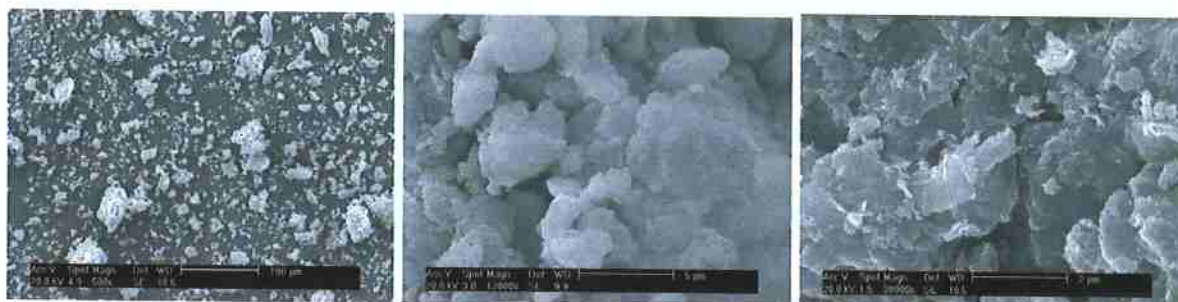
Figura 4.78 - Microscopia eletrônica de varredura da argila C, no estado natural, com aumentos de 500, 12000 e 30000 vezes (escalas de 100, 5 e 2 µm, respectivamente).
