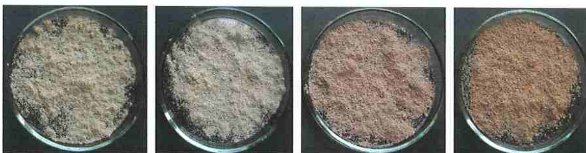
Figura 4.5 - Variação da cor conforme temperatura de tratamento da argila D, natural, 110 °C, 350 °C e 500 °C (da esquerda para a direita).
