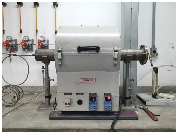
Figura 18. Forno elétrico tubular Grion utilizado para a calcinação da monazita e a desvolatilização dos redutores.
