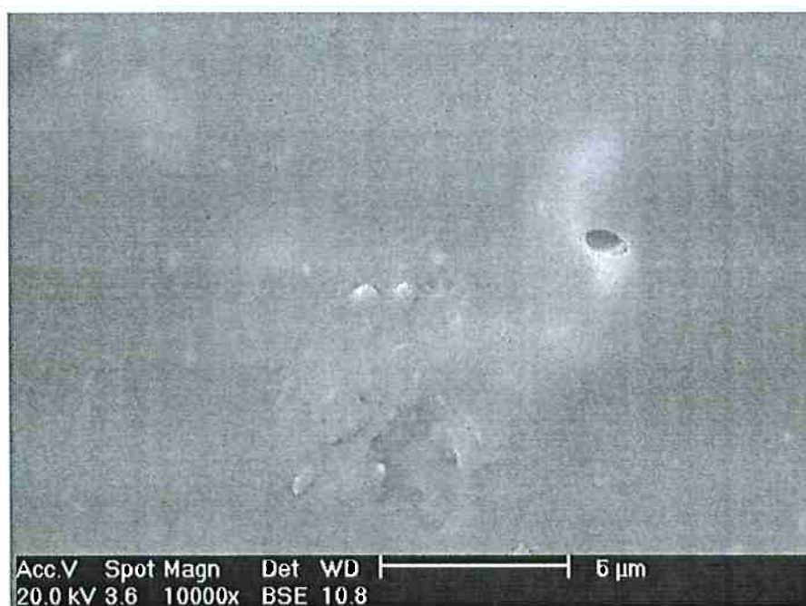
Fig. 67. Microscopia eletrônica de varredura da placa com 40 pcr de cinzas de casca de arroz..
