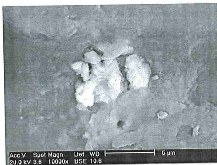
Fig. 69. Microscopia eletrônica de varredura da placa com 10 pcr de cinzas de casca de arroz aditivado.
