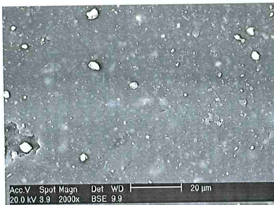
Fig. 78. Microscopia eletrônica de varredura da placas com celulose CEC 10
