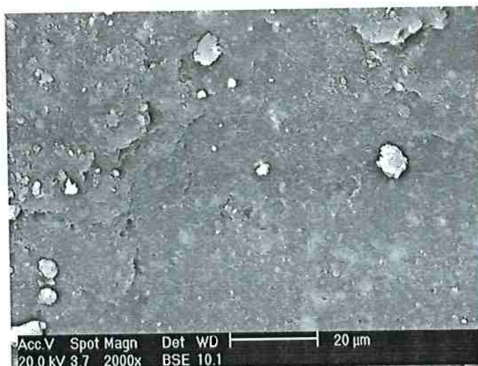
Fig. 70. Microscopia eletrônica de varredura da placa com 40 pcr de carvão antracitoso.
