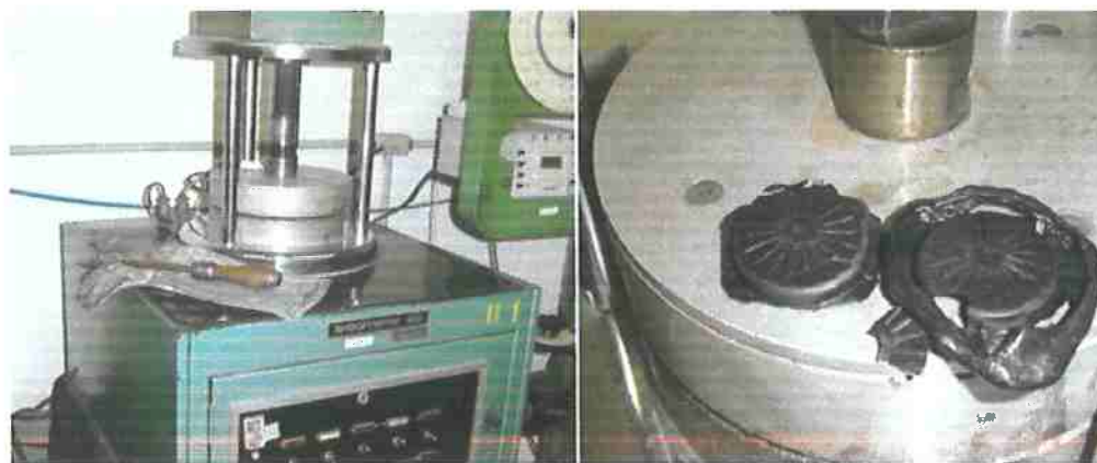
Fig. 12. Reometro utilizado e corpos de prova do ensaio de reometria.
