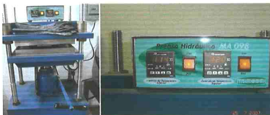
Fig 10 Prensa com aquecimento para vulcanização marca Marconi
