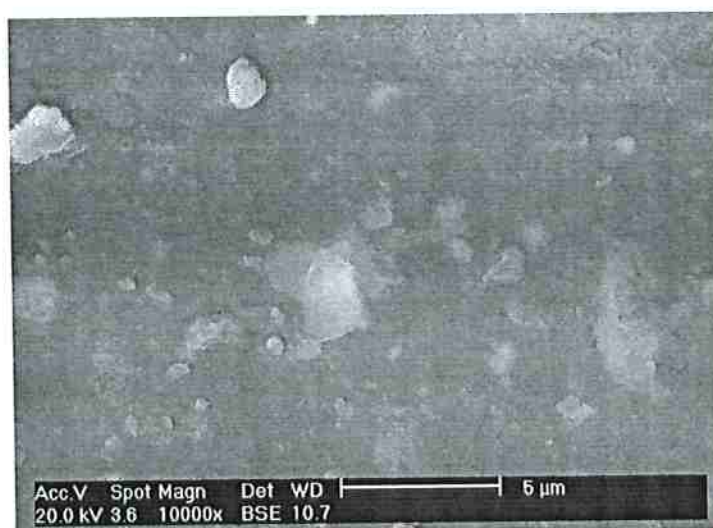
Fig. 65 Microscopia eletrônica de varredura da placa com 10 pcr de cinza de casca de arroz .
