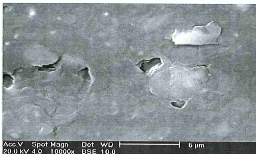
Fig 57 MEV da placa vulcanizada de Borracha Natural.
