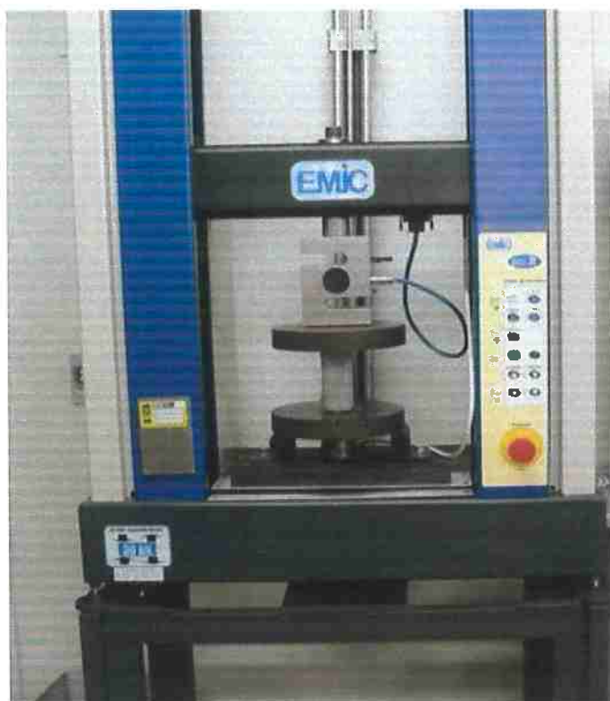
Fig. 13. Máquina universal de ensaios EMIC
