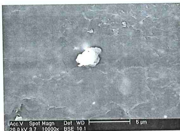
Fig. 71. Microscopia eletrônica de varredura da placa com 40 pcr de carvão antracitoso.
