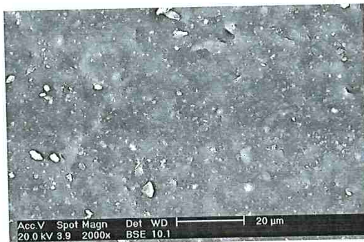
Fig. 72 Microscopia eletrônica de varredura da placa com 40 pcr de carvão antracitoso aditivado.
