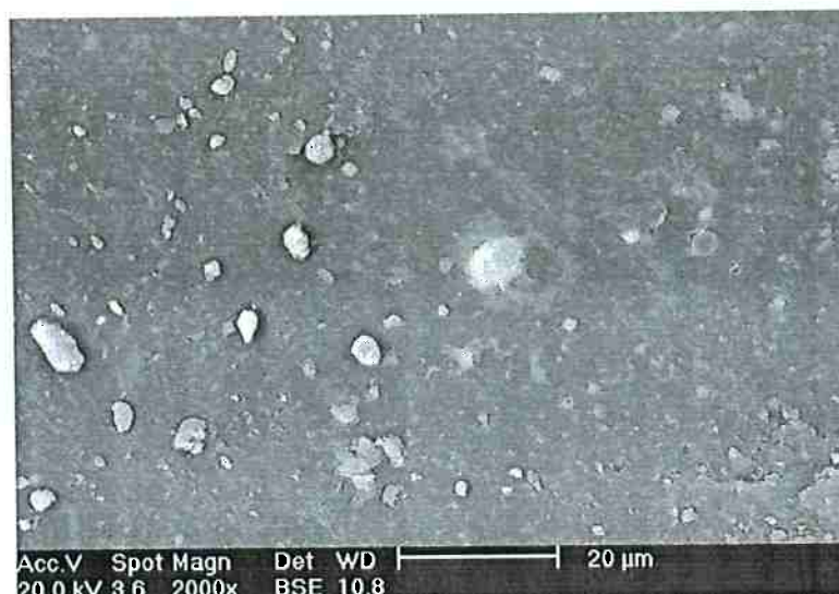
Fig. 64. MEV da placa vulcanizada com 10 pcr de cinza de casca de arroz comercial.
