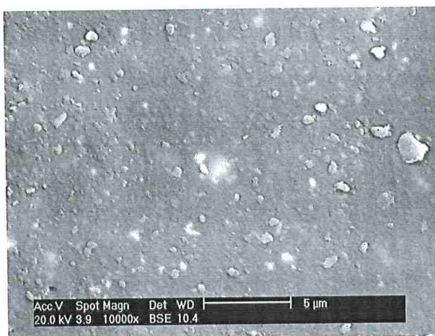
Fig. 75. Microscopia eletrônica de varredura da placa com 10 pcr celulose calcinada (CEA 10).
