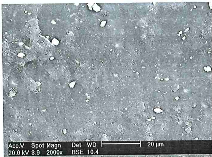
Fig.74. Microscopia eletrônica de varredura da placa com 10 pcr celulose calcinada (CEA 10).
