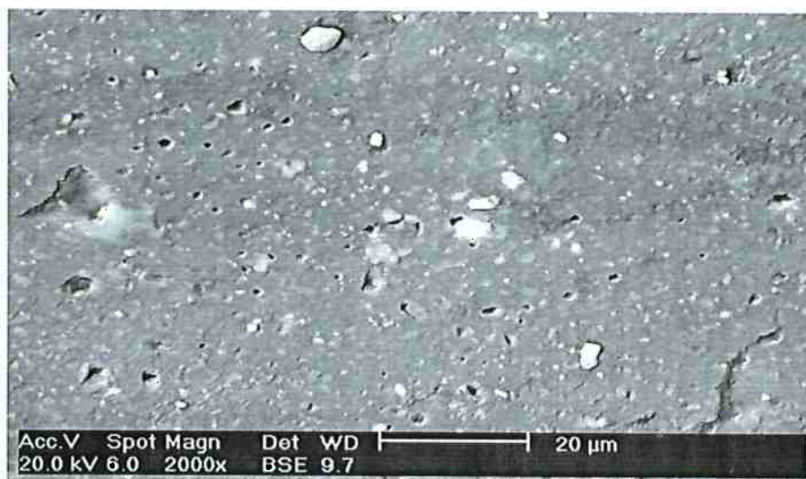
Fig. 56 MEV da placa vulcanizada de Borracha Natural
