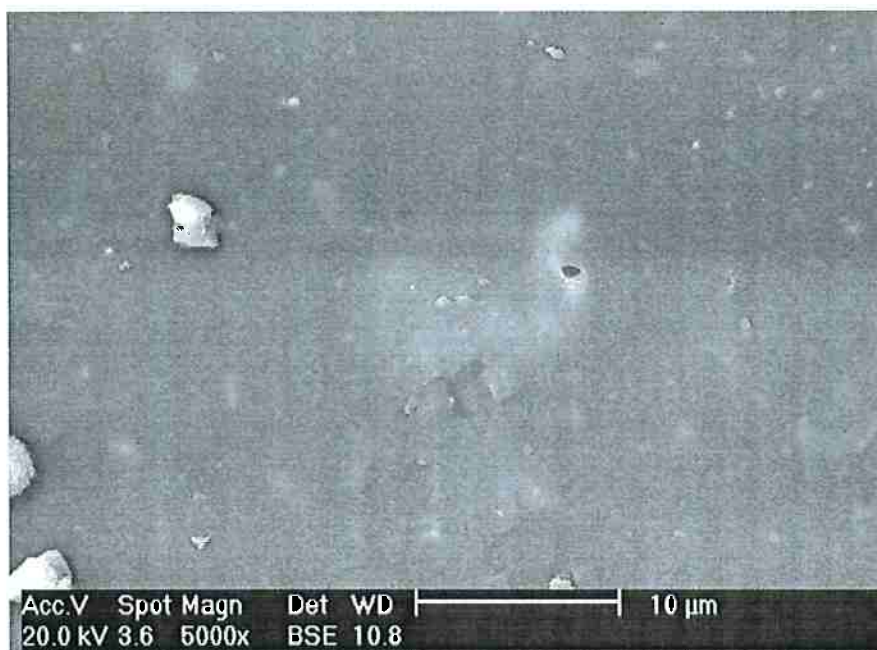
Fig. 66. Microscopia eletrônica de varredura da placa com 40 pcr de cinza de casca de arroz comercial.
