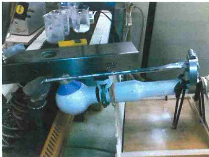
Figura 10. Aparato experimental para controle de alimentação de argila em forma de pó na extrusora.
