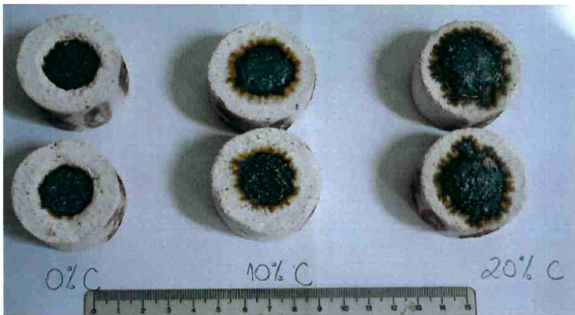
Figura 59 – Corpos de prova das composições 0, 10 e 20%, após ensaio estático de escorificação a 1500°C por 2 horas.
