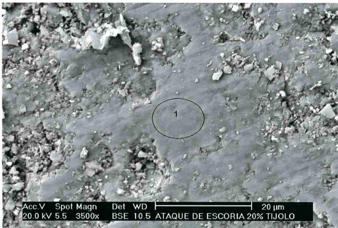
Figura 76 – Corpo de prova com 20% de grafite, após ensaio de escorificação região do corpo de prova (tijolo). A microanálise foi feita na região 1 marcada na Figura.
