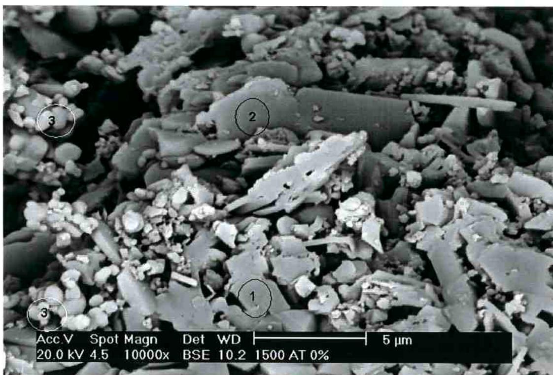
Figura 41 – Imagem do material com 0% de grafite, tratado a 1500°C e atacado termicamente. Os pontos 1, 2 e 3 foram analisados por micro-análise. Nos detalhes marcados em branco, pontos "3", pode-se verificar a formação de espinélio, conforme evidenciado por EDS.
