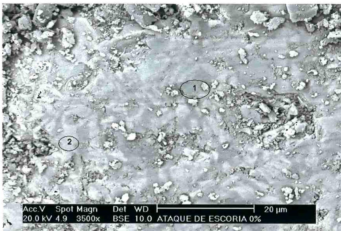
Figura 62 – Corpo de prova sem grafite, após ensaio de escorificação, região onde só se encontra escória. Verificam-se regiões mais escuras (região 1) e regiões mais claras (região 2) na microestrutura.
