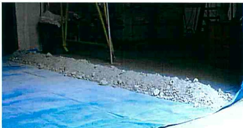
Figura 13 – Disposição da borra seca na forma de uma pilha alongada.
