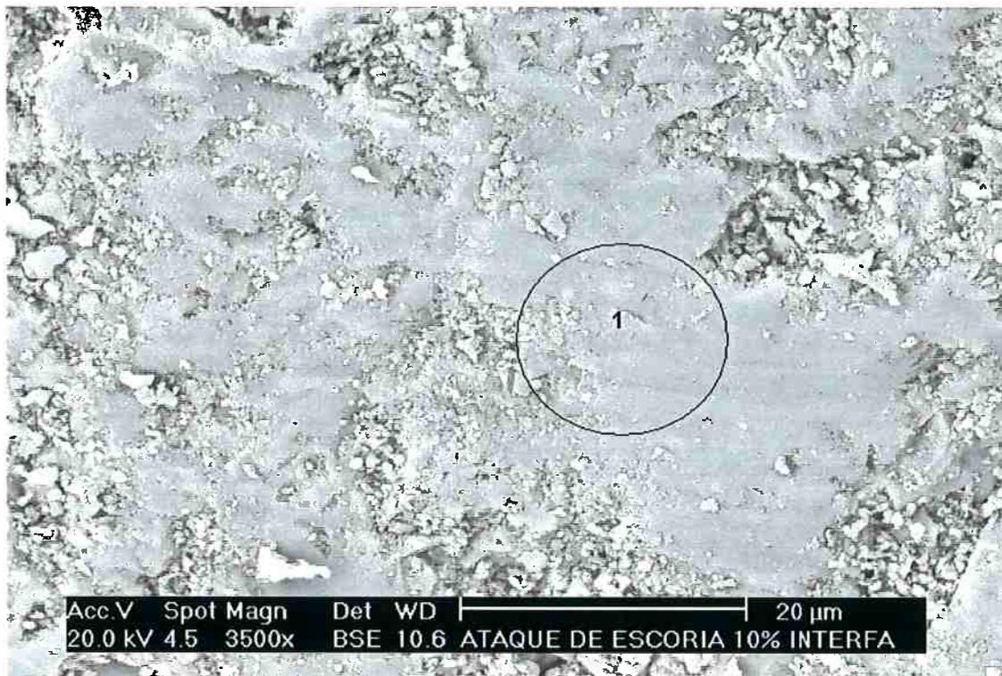
Figura 70 – Corpo de prova com 10% de grafite, após ensaio de escorificação, região da interface escória / corpo de prova. A microanálise foi feita na região 1 marcada na Figura.
