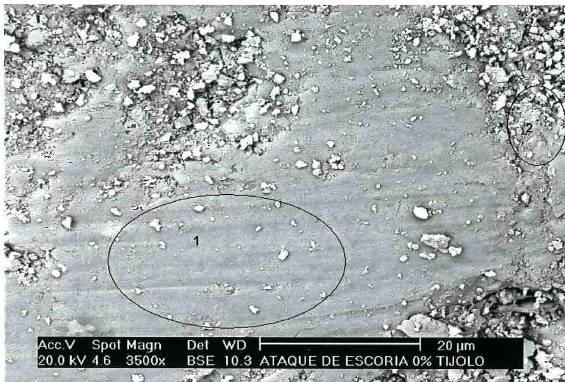
Figura 67 – Corpo de prova sem grafite, após ensaio de escorificação, região assinalada como “tijolo”. Verificam-se regiões mais uniformes (região 1) e regiões mais porosas, com partículas soltas na superfície (região 2).
