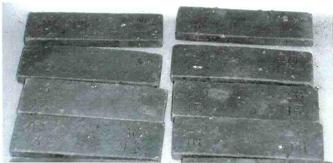
Figura 21 - Corpos de prova prismáticos das composições 10% (esquerda) e 20% após tratamento térmico a 1000°C.
