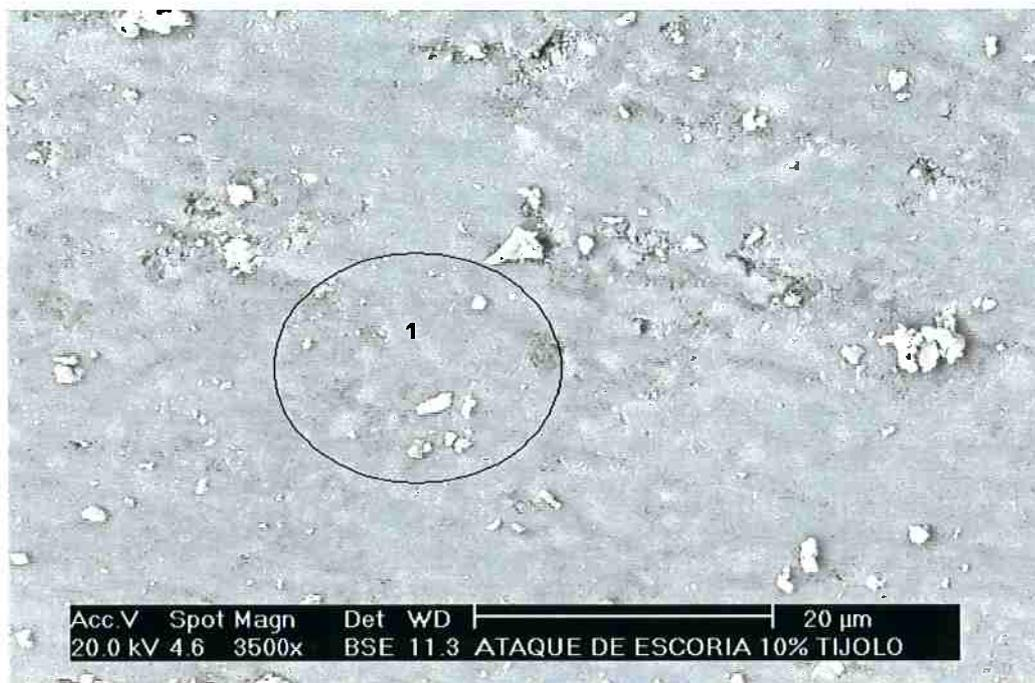
Figura 71 – Corpo de prova com 10% de grafite, após ensaio de escorificação, região do corpo de prova (tijolo). A microanálise foi feita na região 1 marcada na Figura.
