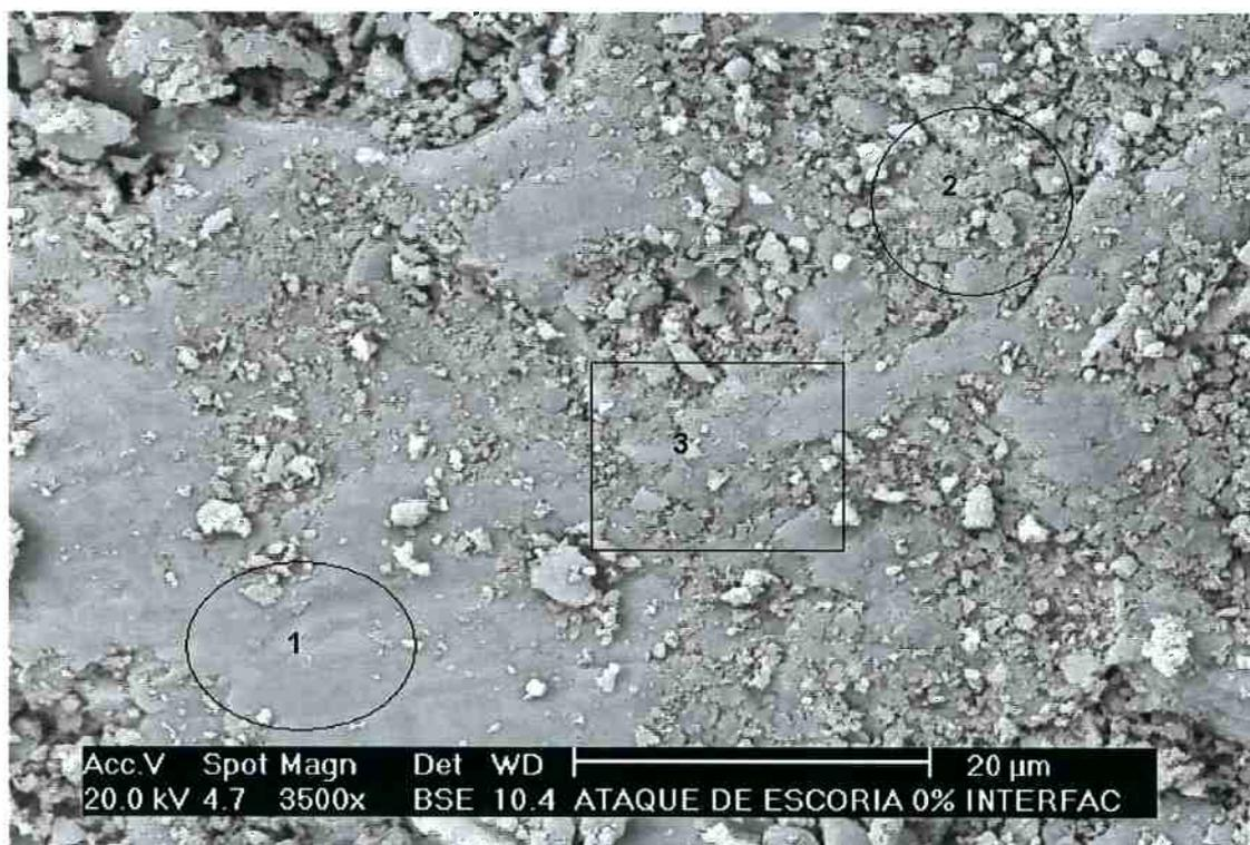
Figura 65 – Corpo de prova sem grafite, após ensaio de escorificação, região da interface escória / corpo de prova (assinalada na Figura 61). Verificam-se regiões mais uniformes (região 1) e regiões mais porosas e com partículas soltas na superfície (região 2). A microanálise foi feita na região 3 marcada na Figura.
