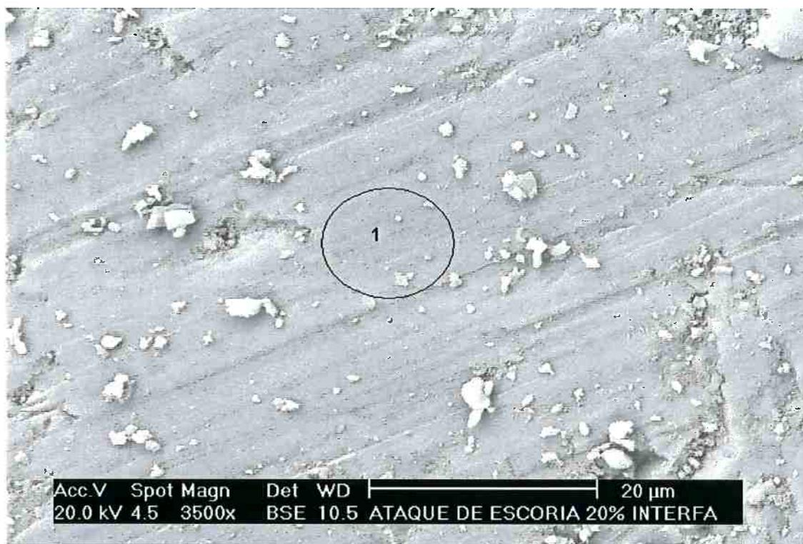
Figura 75 – Corpo de prova com 20% de grafite, após ensaio de escorificação, região da interface escória / corpo de prova. A microanálise foi feita na região 1 marcada na Figura.
