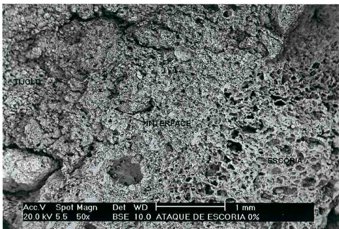
Figura 61 – Corpo de prova sem grafite, após ensaio de escorificação. As regiões onde serão feitas as microanálises e as micrografias, estão indicadas na figura, mostrando a região da escória, da interface escória / corpo de prova e a região do corpo de prova pouco afetada pela escória (tijolo).
