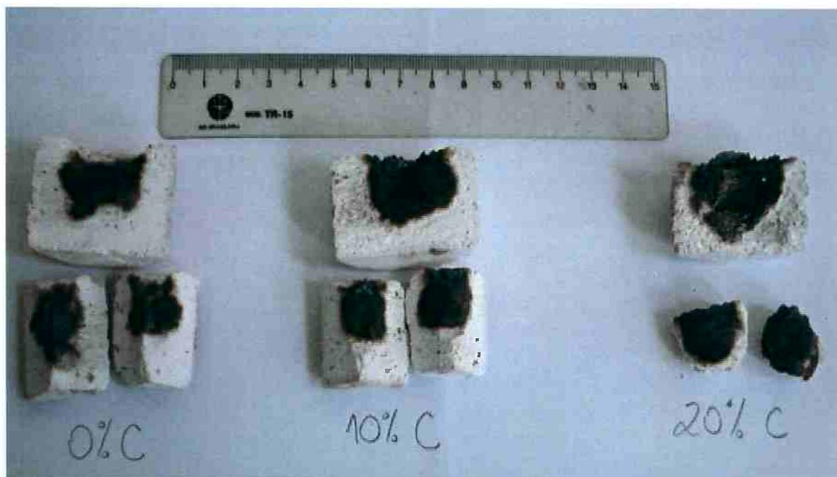
Figura 60 – Corpos de prova das composições 0, 10 e 20%, cortados após ensaio estático de escorificação a 1500°C. Essas regiões cortadas foram polidas e analisadas por MEV e EDS.
