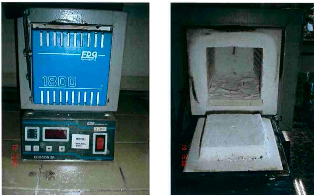
Figuras 15 e 16 - Forno EDG usado para curar os corpos de prova prismáticos.
