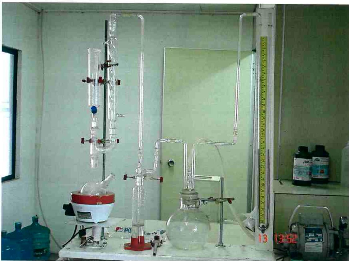
Figura 19 - Dispositivo utilizado para análise de alumínio livre, no IPT.
