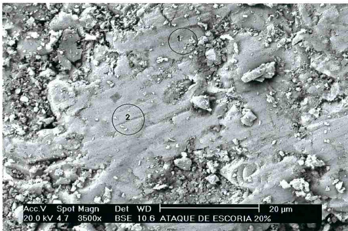
Figura 74 – Corpo de prova com 10% grafite, após ensaio de escorificação, região onde só se encontra escória (assinalada na Figura 73). Verificam-se regiões mais escuras (região 1) e regiões mais claras (região 2) na microestrutura.
