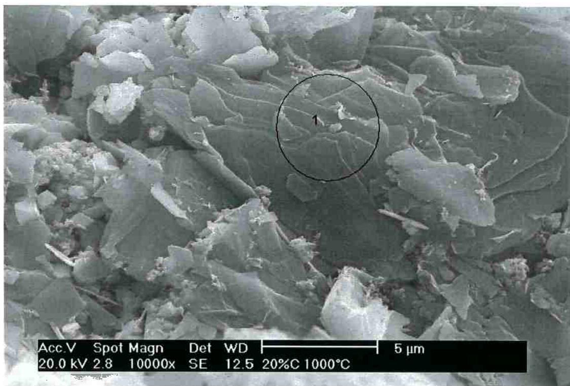
Figura 52 – Micrografia da composição 20%, tratada a 1000°C. A região marcada com o número 1 mostra as lâminas de grafite encontradas no material e evidenciadas pelo EDS da Figura 53. Os valores característicos da presença das lamelas de grafite estão na Tabela XIX.
