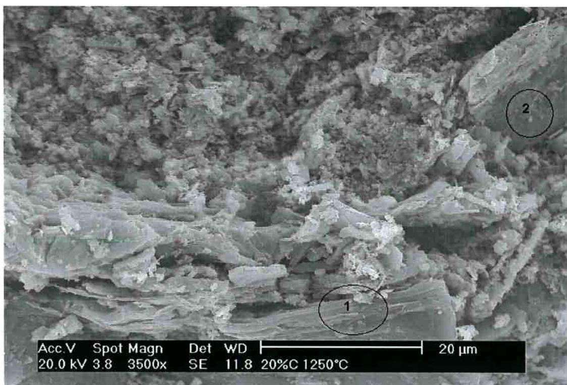
Figura 54 – Micrografia da composição 20%, tratada a 1250°C. A região marcada com o número 1 mostra as lâminas de grafite encontradas no material e a região com o número 2 é mais rica em alumina, conforme Tabela XX.
