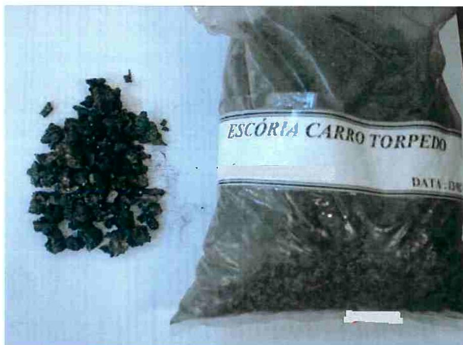
Figura 18 - Escória utilizada para ensaio de escorificação.
